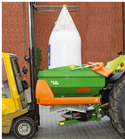
Befüllung mit Bigbag
