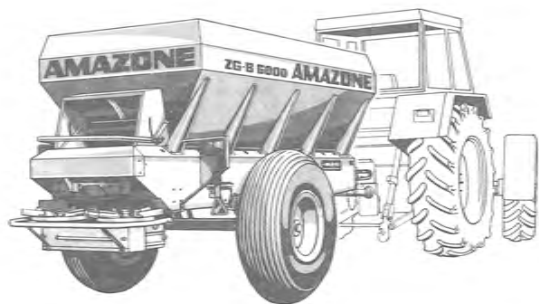
Großflächenstreuer ZG-B 6000 mit Bandboden.
