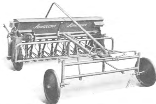
Drillmaschine AMAZONE D1, 1949.
