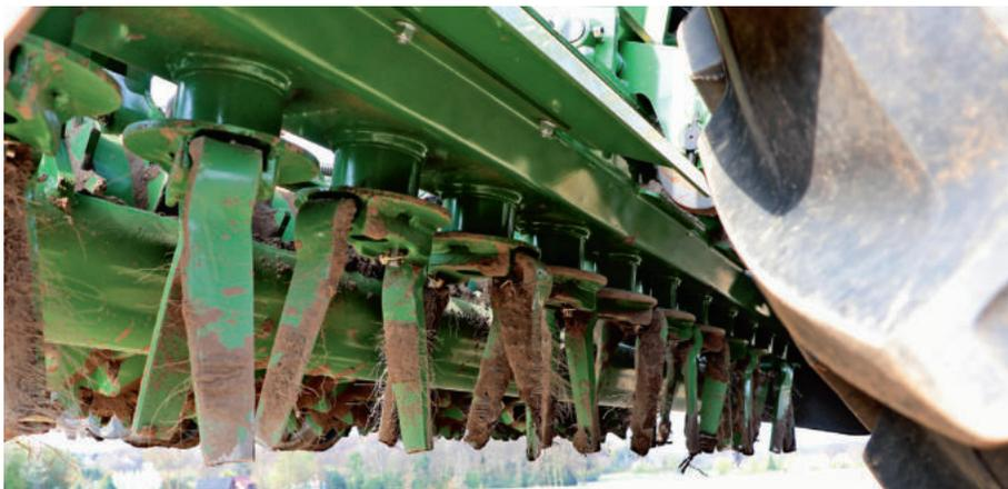
Kleine auf Schlepp stehende Kreisel sind das Hauptmerkmal der neuen KE 3002. Sie verträgt mehr Traktorleistung, ist aber leichter.
