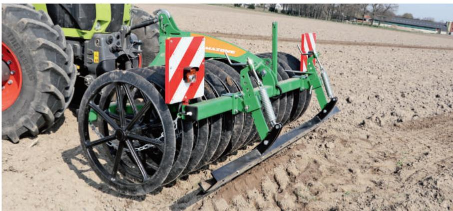
Mit dem Nautilus hat Amazone nun einen lenkbaren Frontpacker mit 900er-Gussringen im Programm. Er sorgt für eine gute Rückverfestigung.
