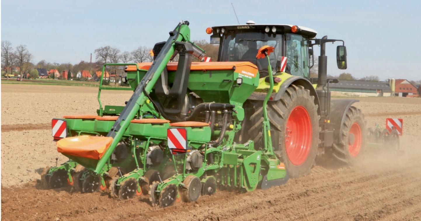
Mit der Kombination aus Frontpacker, Kreiselegge und Einzelkornsämaschine reicht ein Arbeitsgang nach dem Pflug zur Aussaat.
