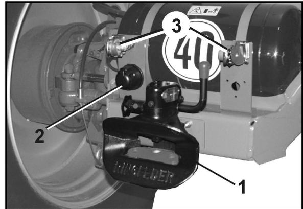
Zum Entriegeln der Zugvorrichtung den Drehknopf (1) ziehen und drehen bis er in der oberen Nut (2) einrastet. Dann den Hebel (3) nach oben schwenken bis der Bolzen entriegelt.
