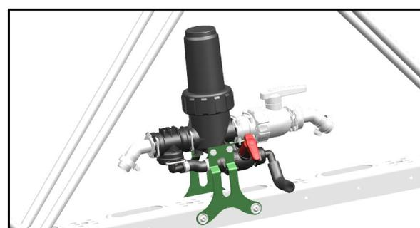
23. Handwaschvorrichtung entwässern und Hahn geöffnet lassen.
