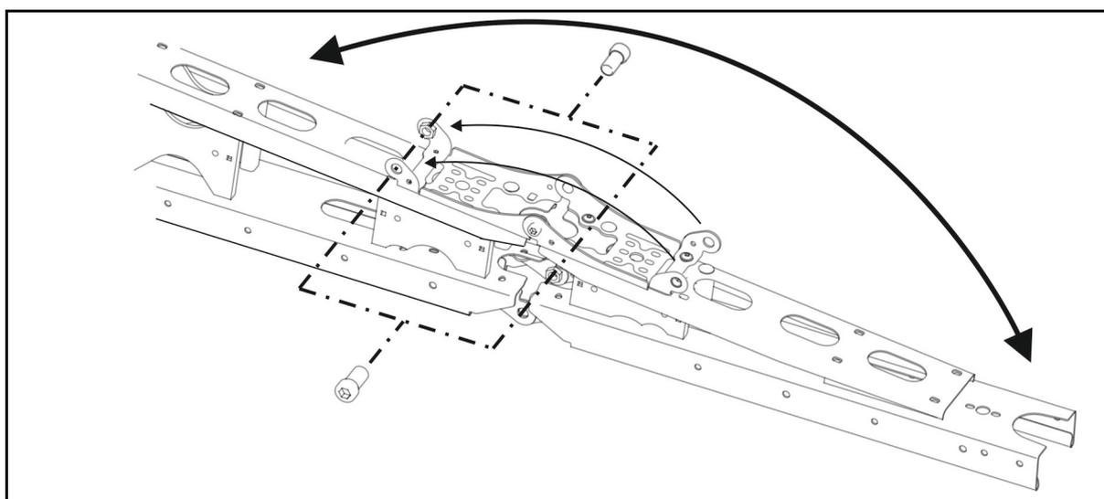
2 Schrauben sichern das eingeklappte und ausgeklappte, äußere Element in den jeweiligen Endstellungen.
