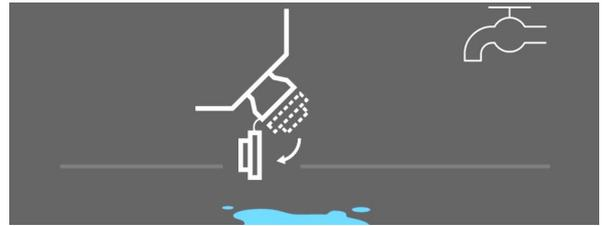
17. Saugschlauch oder Kappe vom Sauganschluss entfernen.
