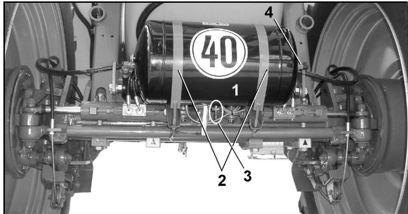
1. Ziehen Sie das Entwässerungs-Ventil über den Ring, solange in seitlicher Richtung, bis kein Wasser mehr aus dem Luftbehälter ausfließt.
