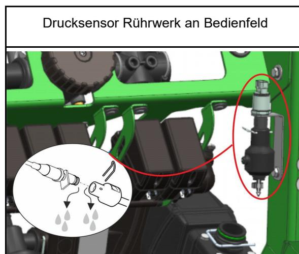
22. Verbliebenes Restwasser im Ablauf der LeitungsfILTER mit Ablasshahn ablassen.
