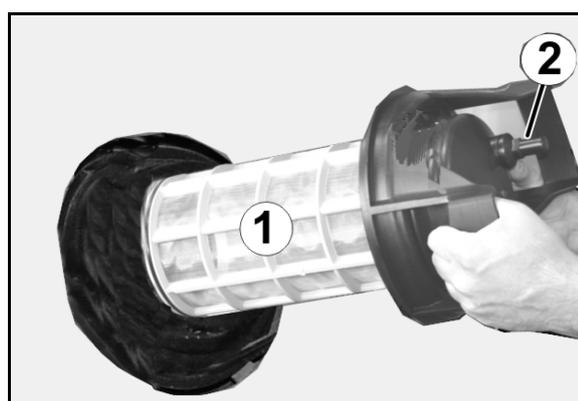
**Druckfilter bei befülltem Spritzflüssigkeitstank reinigen**
