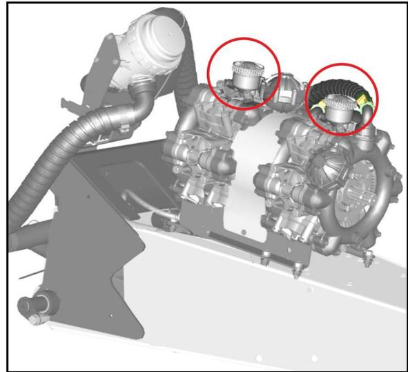
1. Kontrollieren, ob der Ölstand an der Markierung bei nicht laufender und waagrecht stehender Pumpe sichtbar ist.
