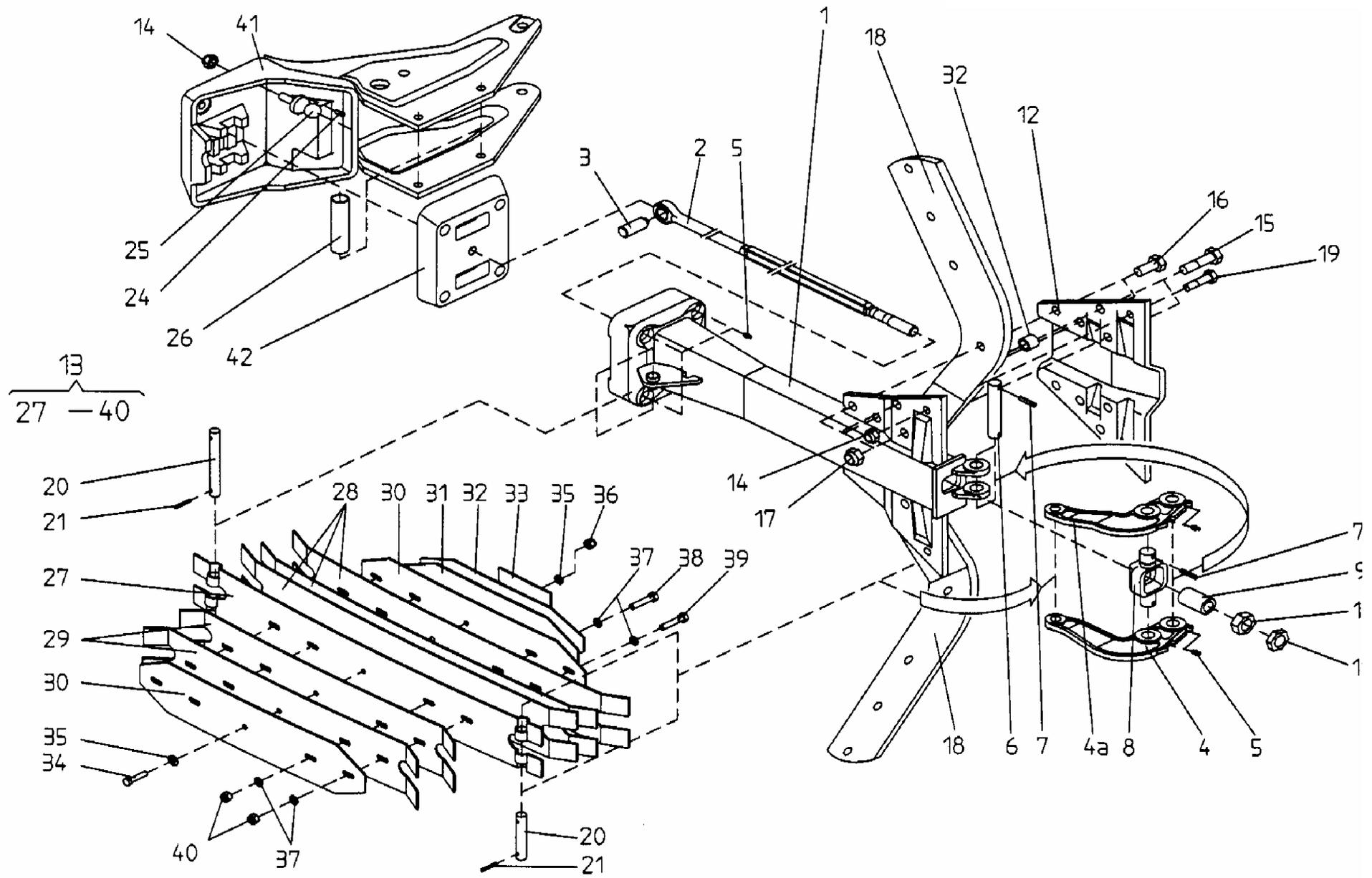
**NON-Stop-Steinsicherung („M-VARIO“, „MS-VARIO“, „S-VARIO“)**
