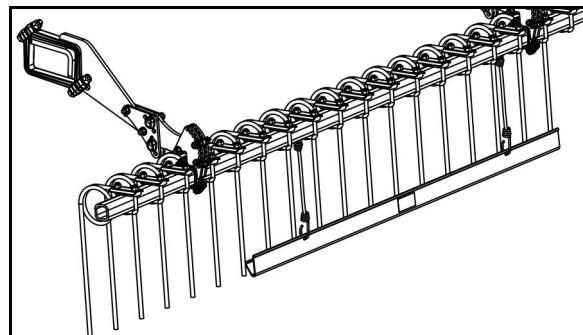
Система уборки с пружинными элементами
