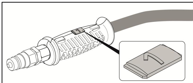
На агрегате размещены наклейки с пояснением соответствующих гидравлических функций, обозначаемых маркировкой.
