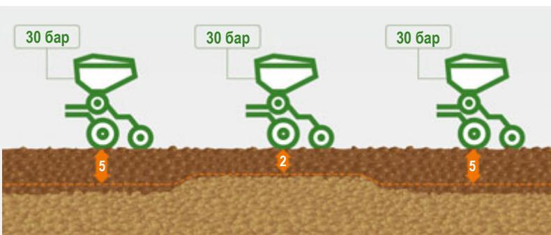
Гидравлическая регулировка давления на сошник без автоматики
