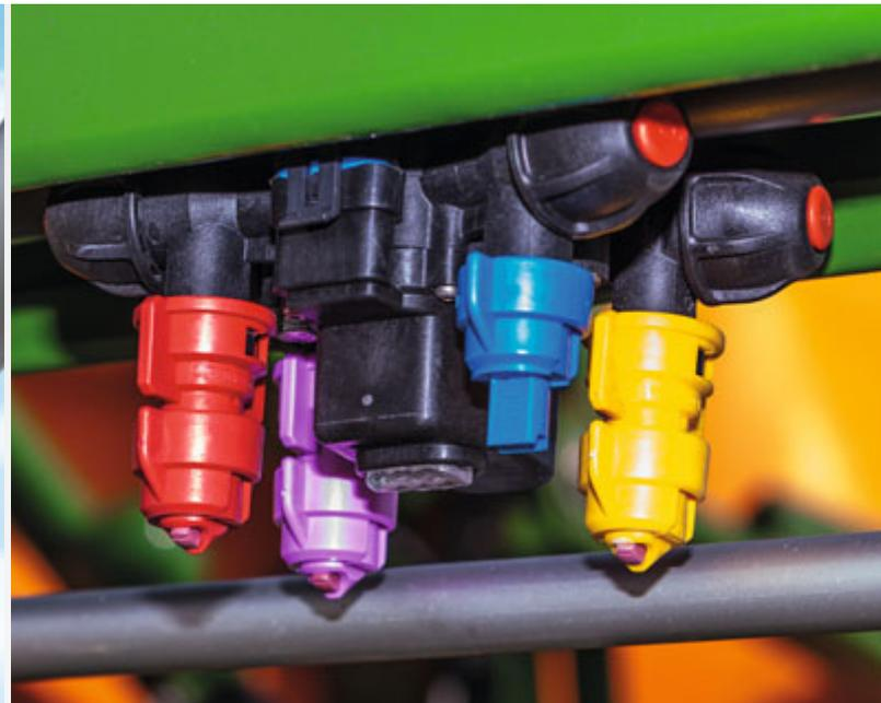
AmaSelect с 4-корпусным держателем форсунок и индивидуальной светодиодной подсветкой
