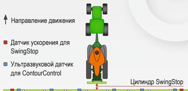
Штанга AMAZONE с системой SwingStop для идеального ведения штанги по горизонтали
