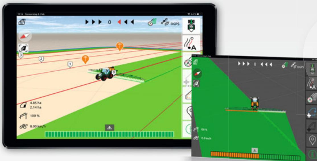
Вид карт с AmaTron Twin – Наглядное изображение эксплуатируемой машины и ее секций, а также кнопки на правой стороне дисплея планшета
