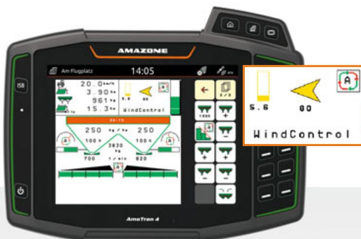
Скорость и направление ветра отображаются на терминале
