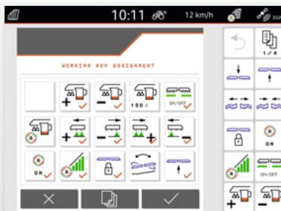
Каждая кнопка может быть запрограммирована механизатором индивидуально под соответствующую функцию
