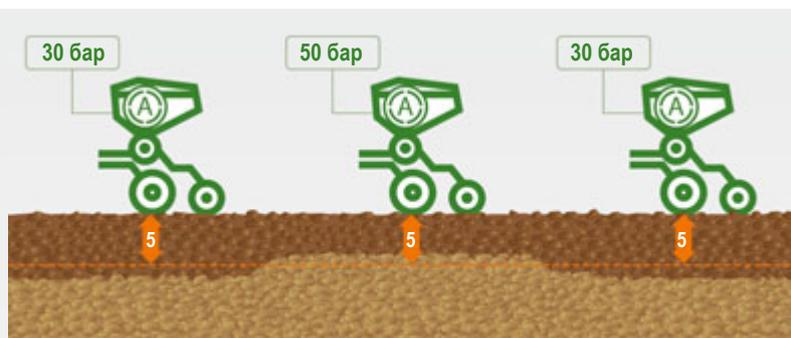
Гидравлическая регулировка давления на сошник с автоматикой
