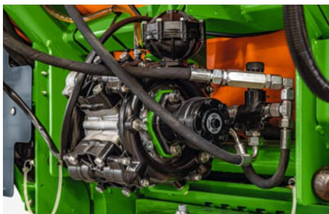
Hydraulischer Pumpenantrieb, mit Sicherheitsventil gegen Überdrehzahl und falsche Verschlauchung am Traktor
