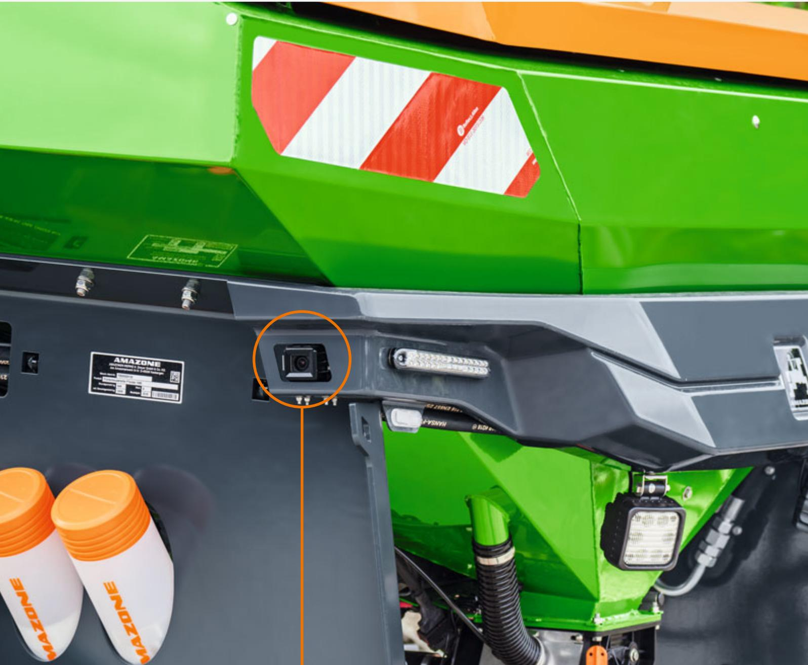
Das zertifizierte Kamerasystem sorgt am Frontanbaugerät FTender 1600 (ohne Frontreifenpacker T-Pack F) für eine sichere Fahrt
