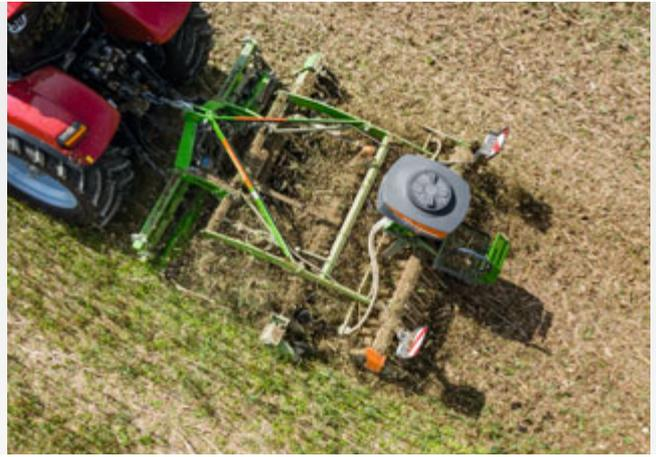
Die X-Cutter-Disc sorgt für einen besonders hohen Anteil an Feinerde. Das sorgt bei gleichzeitiger Ausbringung von Zwischenfrüchten für optimale Keimbedingungen.
