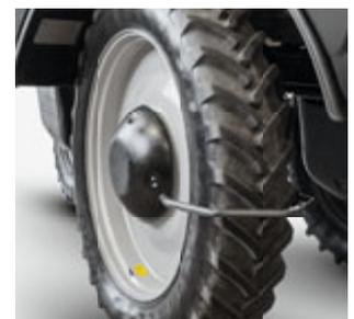
Radgetriebeabdeckung und Halmteiler an der Pantera 4504-HW
