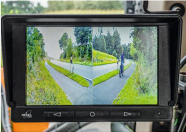
Die am Frontanbaugerät links und rechts installierten Kameras machen den Querverkehr über den geteilten Monitorbildschirm in unübersichtlichen Ausfahrten jederzeit einsehbar
