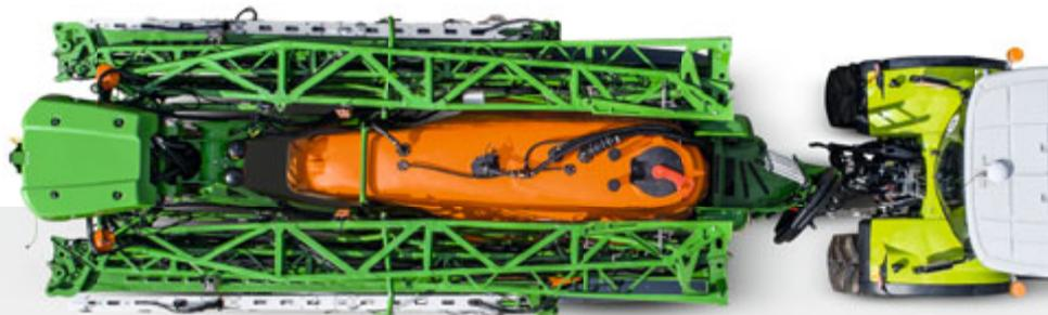
42 m Arbeitsbreite kompakt geklappt für den sicheren Straßentransport
