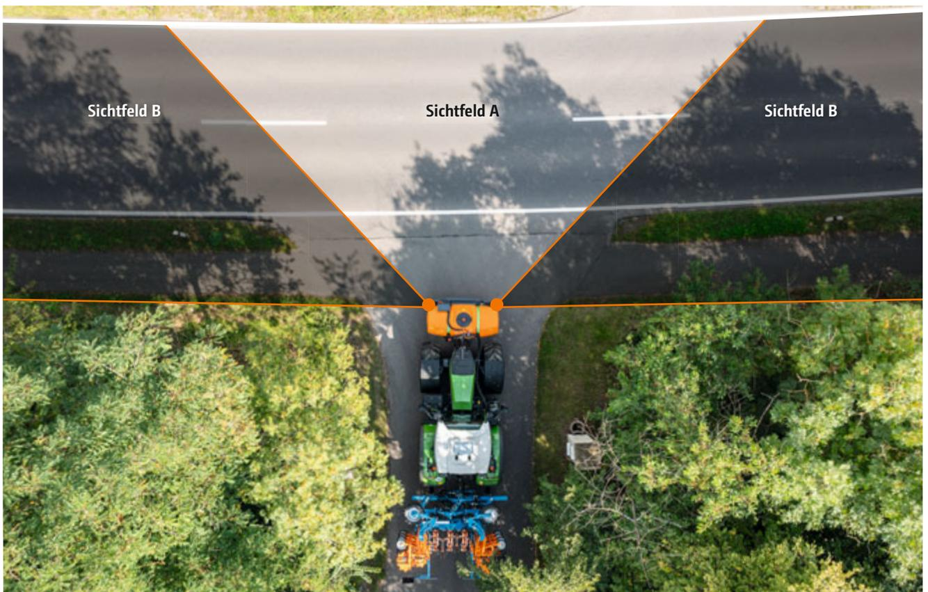
Durch den Einsatz von Einrichtungen für indirekte Sicht (**Sichtfeld B**), z. B. ein Kamera-Monitor-System, kann in Kombination mit der direkten Sicht des Fahrzeugführers (**Sichtfeld A**) das Seitensichtfeld abgedeckt werden.
