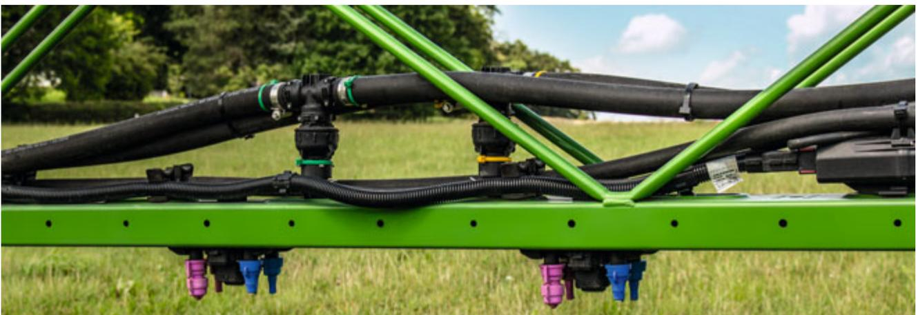
Das Gestänge verfügt über zwei separate Zuleitungen, gelb und grün, die fernbedient umgeschaltet werden
