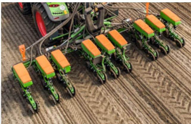
Hydraulische Verschiebefahrgasse bei der Precea 6000-2FCC – symmetrische Anordnung
