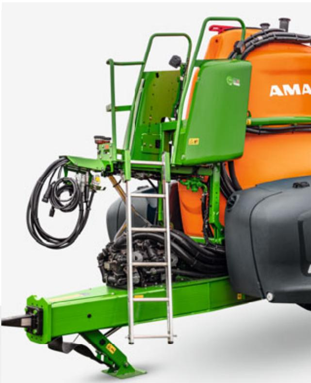
Sicherer Zugang zur Tanköffnung über das große Podest
