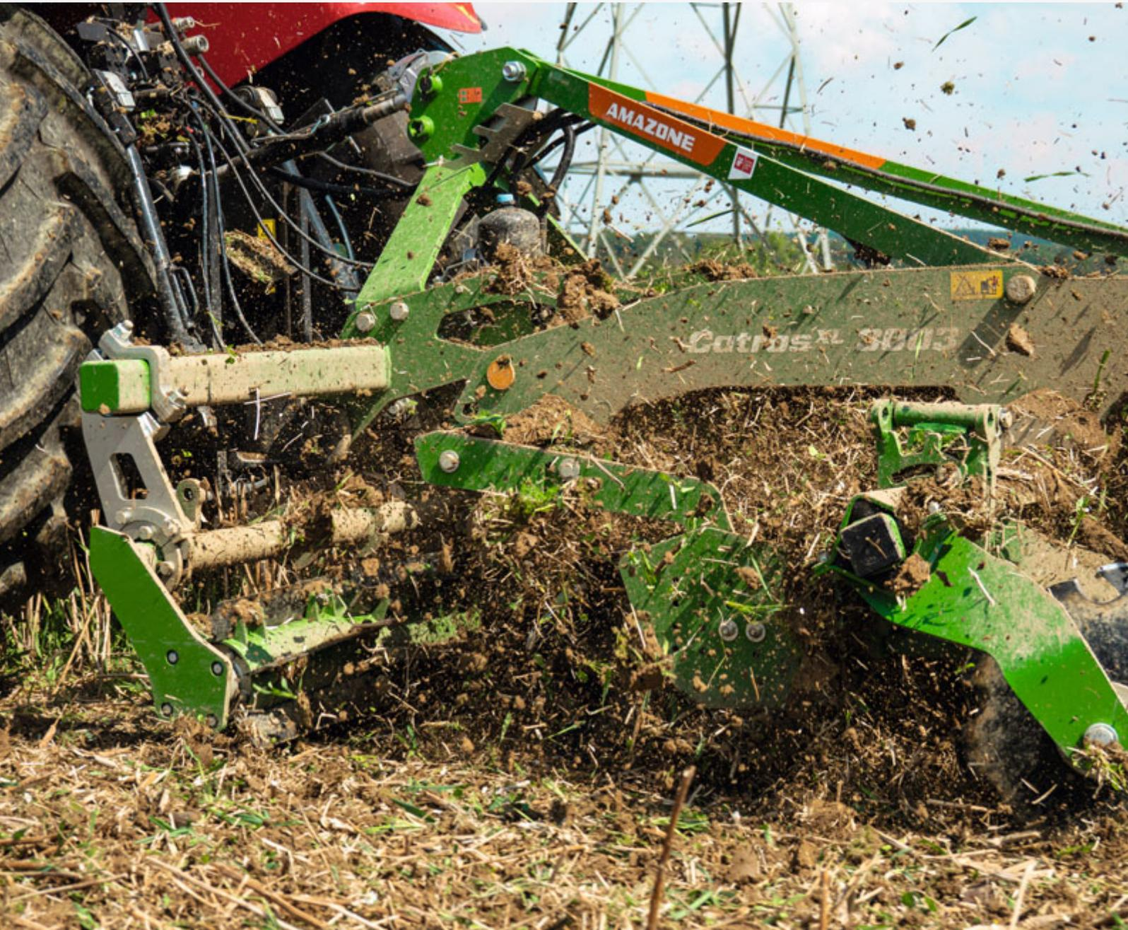
Ultraflache und intensive Mischung des Bodens und Schneiden der Erntereste in Kombination mit der Messerwalze
