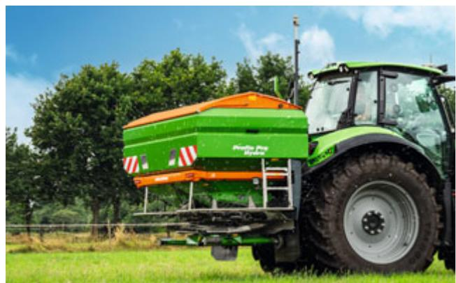
Über den hochfrequent messenden Windsensor werden die Einstellwerte für den Düngerstreuer permanent neu berechnet und automatisch angepasst
