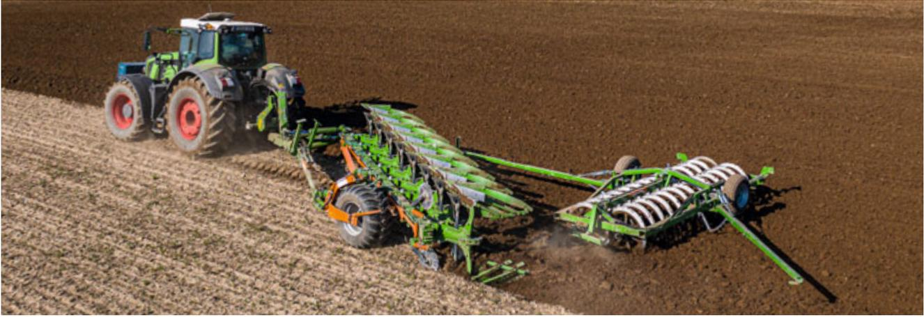
Für noch mehr Effizienz in Ihrem Betrieb erweitert AMAZONE das Packerprogramm durch eine strategische Zusammenarbeit mit der Firma Tigges. Daher besteht nun die Möglichkeit, den Tyrok mit Packern von Tigges im AMAZONE Design zu kombinieren. Es werden verschiedene Ringdurchmesser, sowie unterschiedliche Ringprofile angeboten. Zusätzlich besteht die Auswahl zwischen Einfach- oder Doppelringpacker bis zu einer Arbeitsbreite von 4,65 m.
