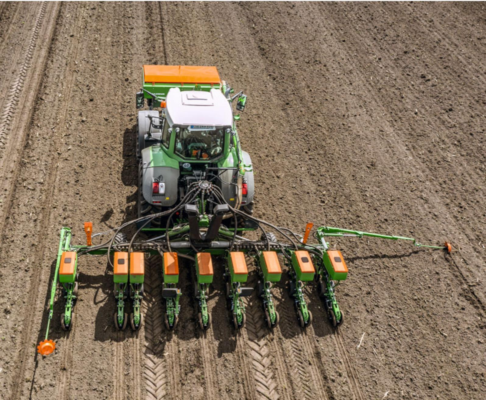
Hydraulische Verschiebefahrgasse bei der Precea 6000-2FCC – asymmetrische Anordnung
