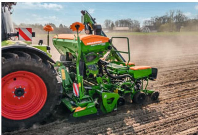
Mit nur wenigen Handgriffen kann die neue KE 3002-240 Rotamix mittels QuickLink beispielsweise mit der neuen Aufbau-Einzelkornsämaschine Precea 3000-A verbunden werden
