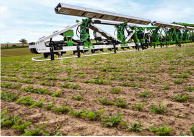
Endausleger mit integrierter Überlastsicherung
