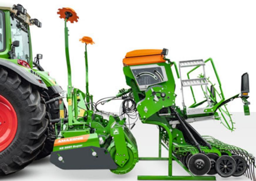
Die Cataya Special kann dank des Schnellkuppelsystems QuickLink sehr einfach mit der entsprechenden Bodenbearbeitung kombiniert werden. Eine Kreisel-egge, ein Kreiselgrubber oder eine Kombination mit der Kompaktscheibenege CombiDisc ist möglich.
