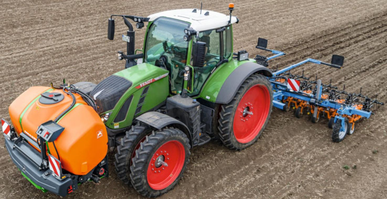
Der Fronttank FT-P 1502 im Einsatz mit einer SCHMOTZER Hackmaschine für die Bandspritzung
