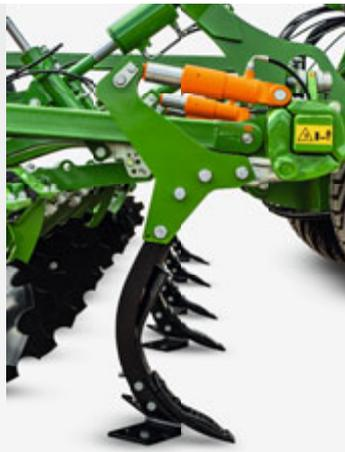
Über den Hydraulikzylinder wird der C-Mix-Ultra-Zinken nach dem Auslösen gedämpft zurückgesetzt
