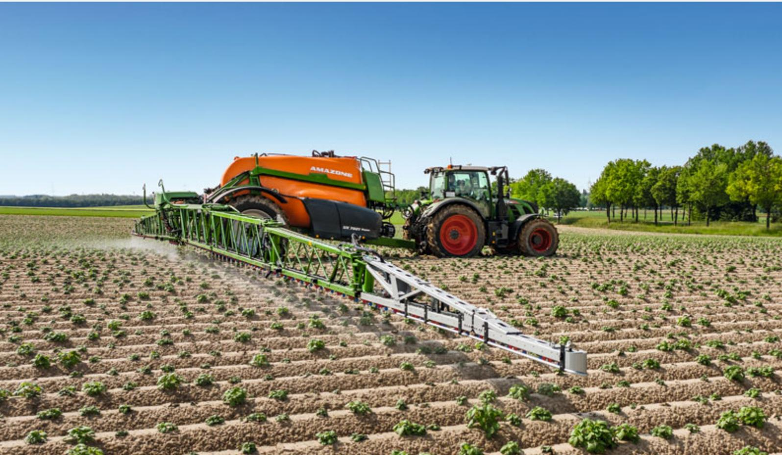
UX 7601 Super mit 42-m-Super-L3-Gestänge: Exakte Gestängeführung dank ContourControl und SwingStop
