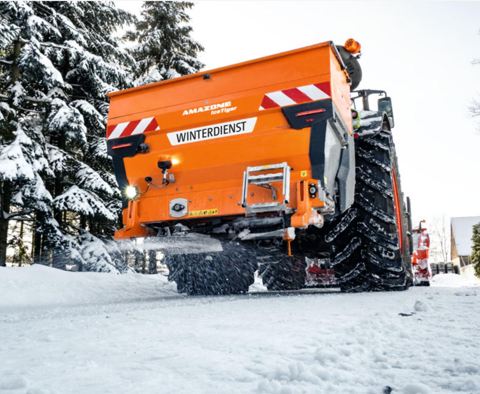
Der IceTiger verfügt über das einzigartige Smart Precision System mit hydraulisch angetriebenem Bandboden, modernster ISOBUS-Steuerung und Präzisionsstreuicheibe
