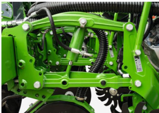
Über den Hydraulikzylinder der Precea Super wird der Schardruck automatisch eingestellt
