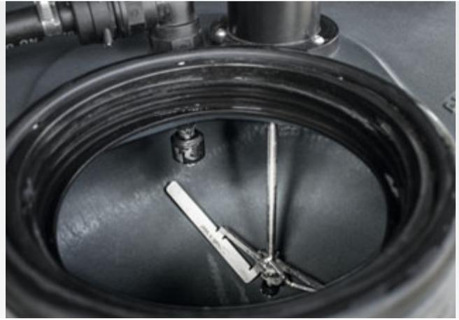
Mechanisches Rührwerk und Reinigungsdüse im DirectInject-Tank
