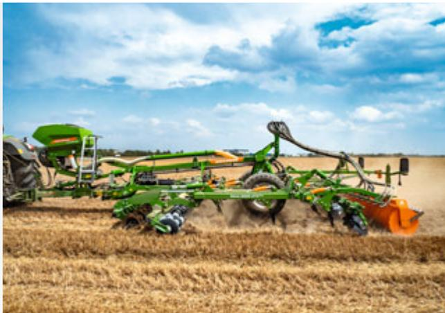
Die hohe Auslösekraft von bis zu 800 kg sorgt für eine gleichbleibende Arbeitstiefe und schützt den Rahmen
