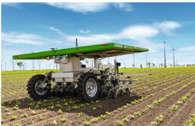
Der FarmDroid-Roboter FD20 ist ausgestattet mit einem GPS-Saatsystem, einem Hackgerät und dem innovativen, präzisen AMAZONE Feldspritzensystem für Spotapplikationen
