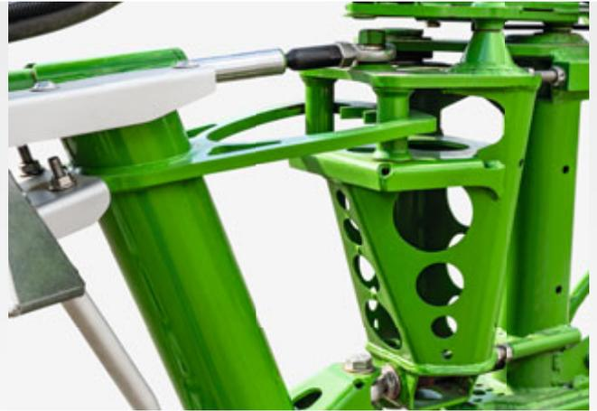
Hydraulische Vorspannung des Endauslegers
