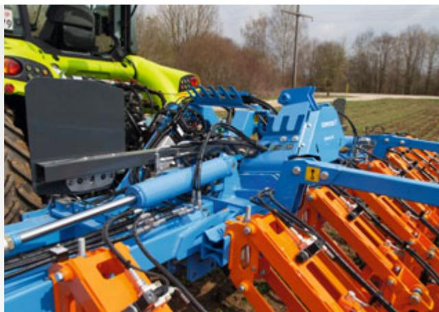
Die kompakte Bauweise der Venterra reduziert die benötigte Frontballastierung des Traktors. Der Abstand der hinteren Parallelogramme zu den Unterlenkern wurde weiter reduziert.
