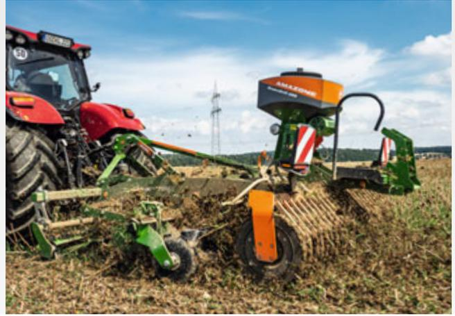
Catros<sup>XL</sup> 3003 mit X-Cutter-Disc, Messerwalze und GreenDrill
