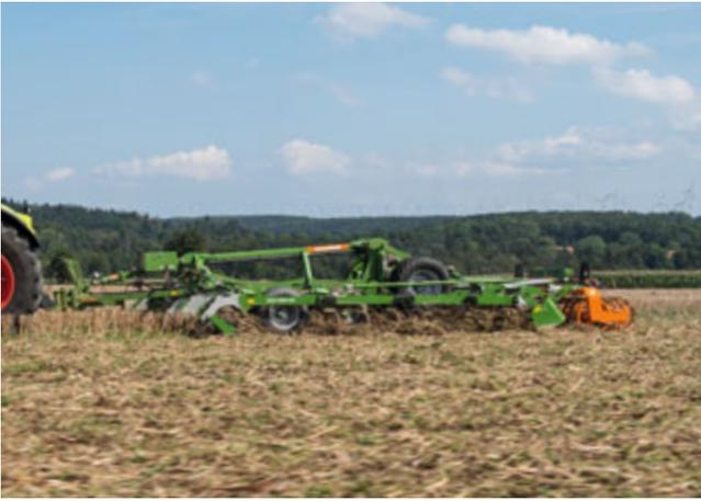
Cobra-2TX mit vorlaufender Messerwalze in der Rapsstoppelbearbeitung
