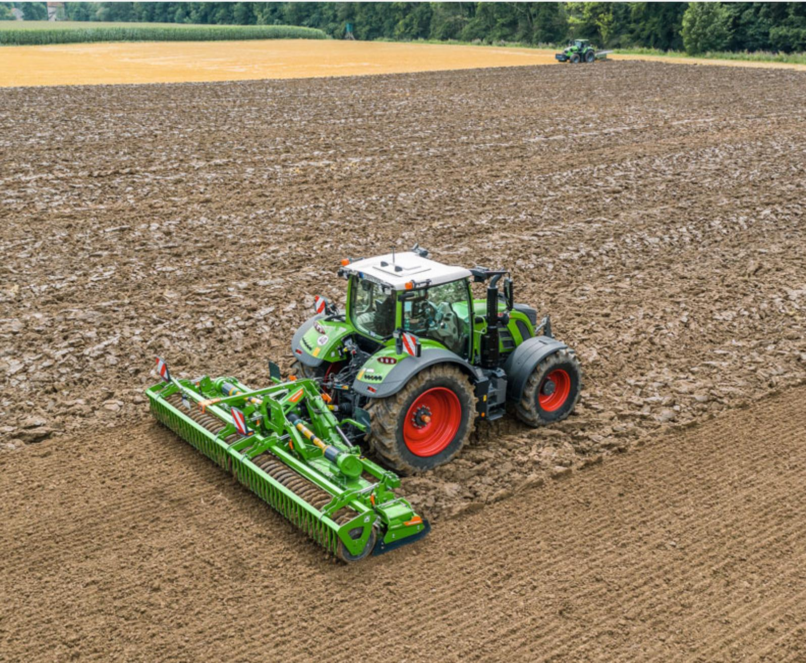
KE 6002-2-400 mit System Rotamix im Einsatz nach der wendenden Bodenbearbeitung
