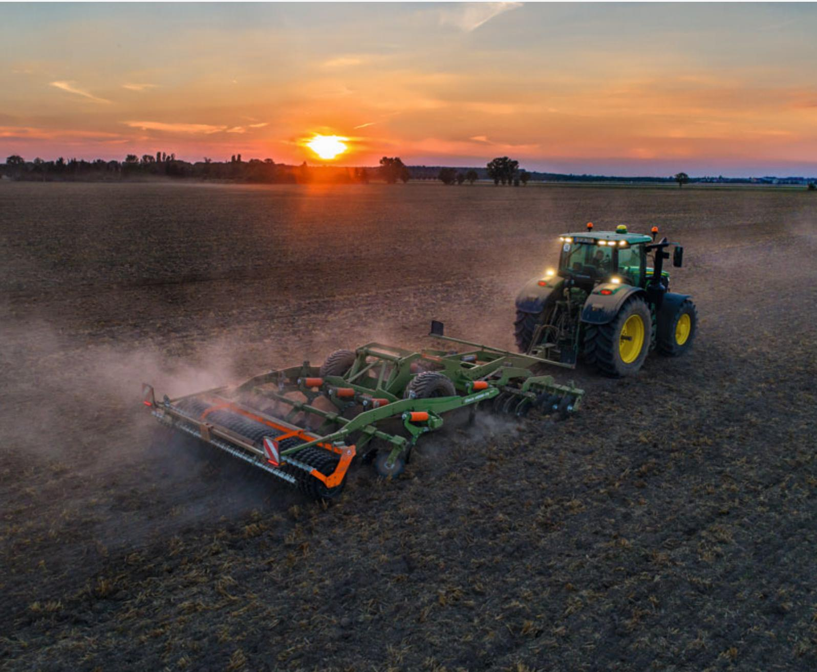
Scheibeneggen-Grubber-Kombination Ceus 4000-TX für intensives Mischen und tiefes Lockern des Bodens
