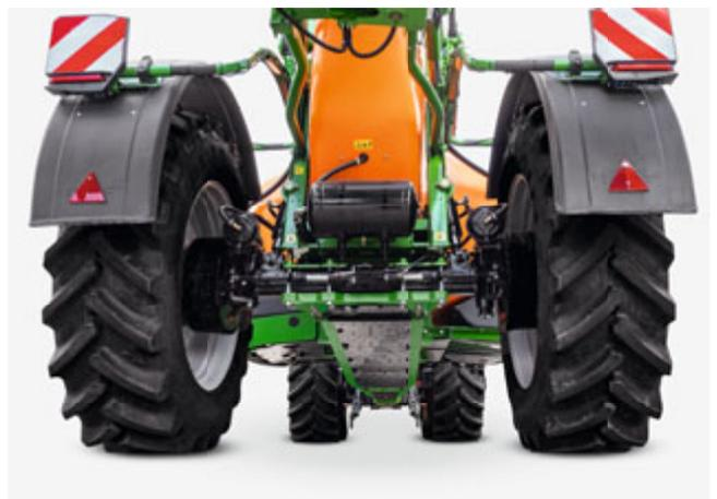
UX 8601 Super mit hydropneumatischer Achsfederung und Unterbodenverkleidung für eine absolut pflanzenschonende Geräteunterseite
