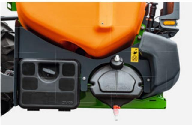
Abschließbares Ablagefach und Handwaschtank mit integriertem Seifenspender auf der rechten Maschinenseite
