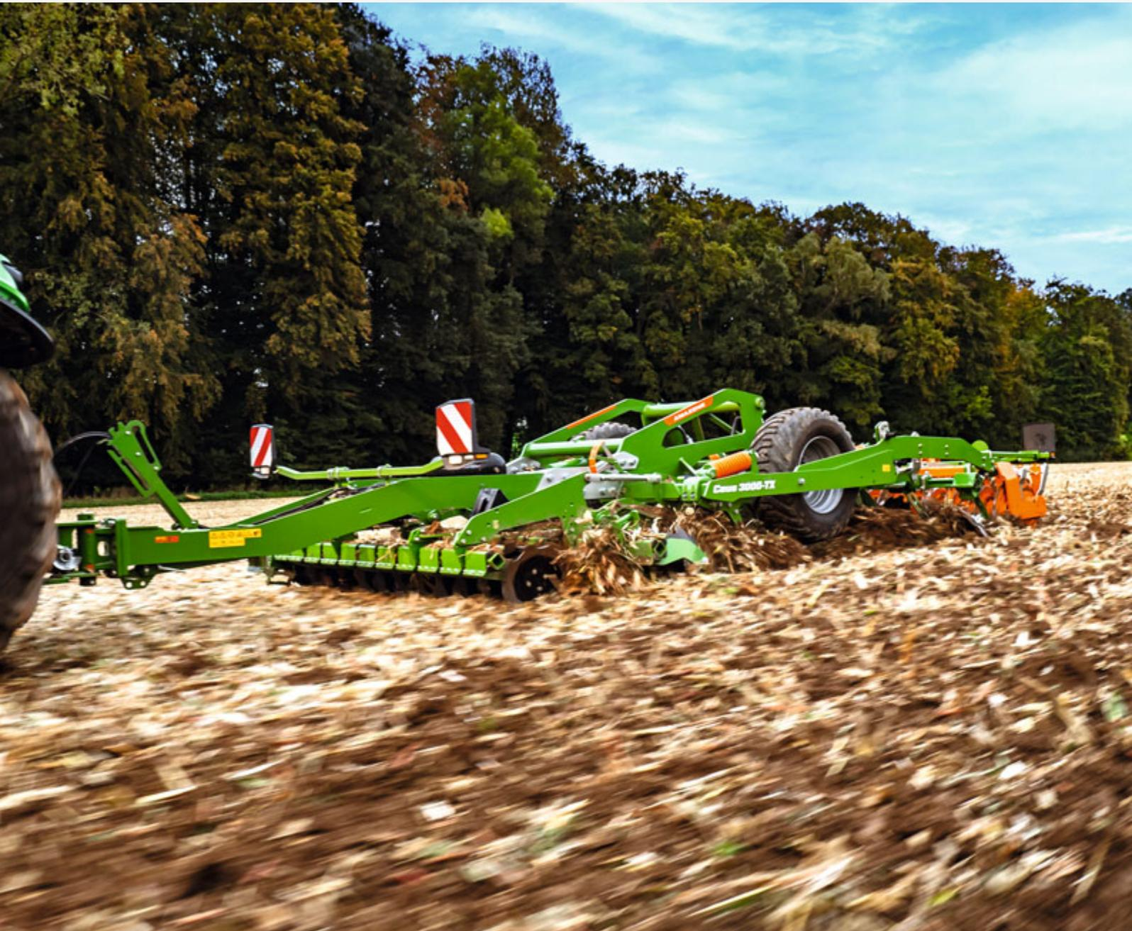
Die neuen Ceus 3000-TX und 4000-TX erzeugen durch die Kombination von Scheiben und Zinken eine perfekte Mischung bei Arbeitsgeschwindigkeiten bis zu 15 km/h
