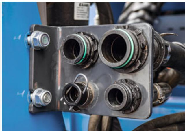
Schnittstelle zwischen Fronttank FT-P 1502 und Teilbreitenarmatur auf dem Arbeitsgerät
