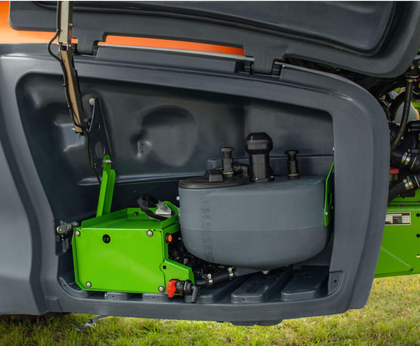
DirectInject-Ausstattung mit 50-l-Tank und Pumpeneinheit im Ablagefach der UX 01 Super
