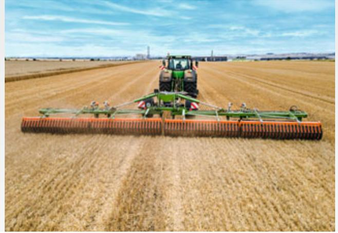
Statt des Striegels kann der Werkzeugträger alternativ auch mit verschiedenen Walzen für eine gute Rückverfestigung ausgestattet werden
