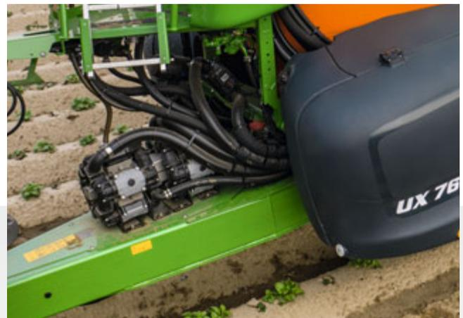
Neue entwickelte Kolbenmembranpumpen mit hydraulischem Antrieb
