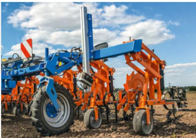
Kamera und Verschieberahmen steuern die Hacke im Heck voll automatisch, sodass der Fahrer entlastet wird.
