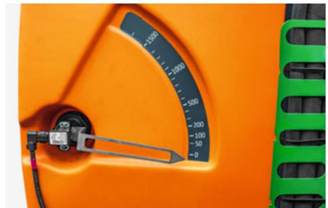
Vom Traktor aus gut sichtbare Füllstandsanzeige
