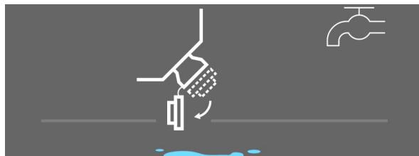
17. Снимите всасывающий шланг или заглушку с всасывающего патрубка.
