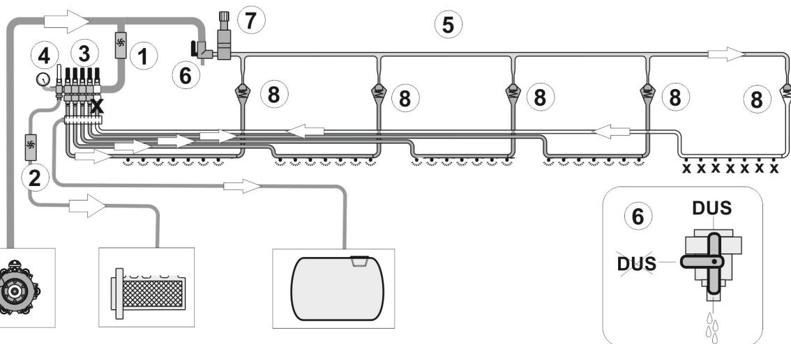
Распределительные трубопроводы с переключением отдельных форсунок и системой принудительной циркуляции DUS Pro
