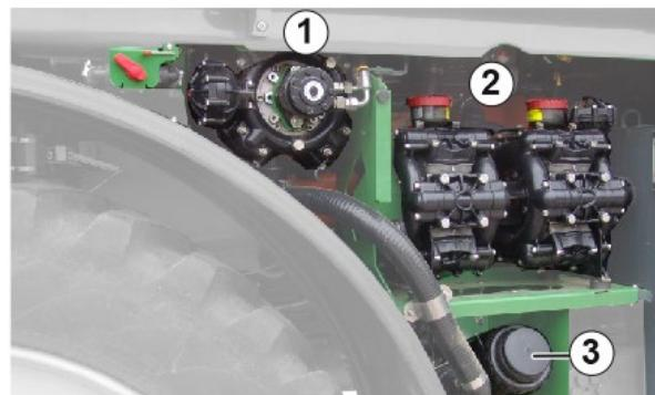
Включение и выключение насосов выполняется автоматически или вручную на терминале TwinTerminal или терминале управления ISOBUS.
