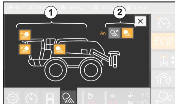
Рабочее освещение штанг переключается на терминале управления ISOBUS.
