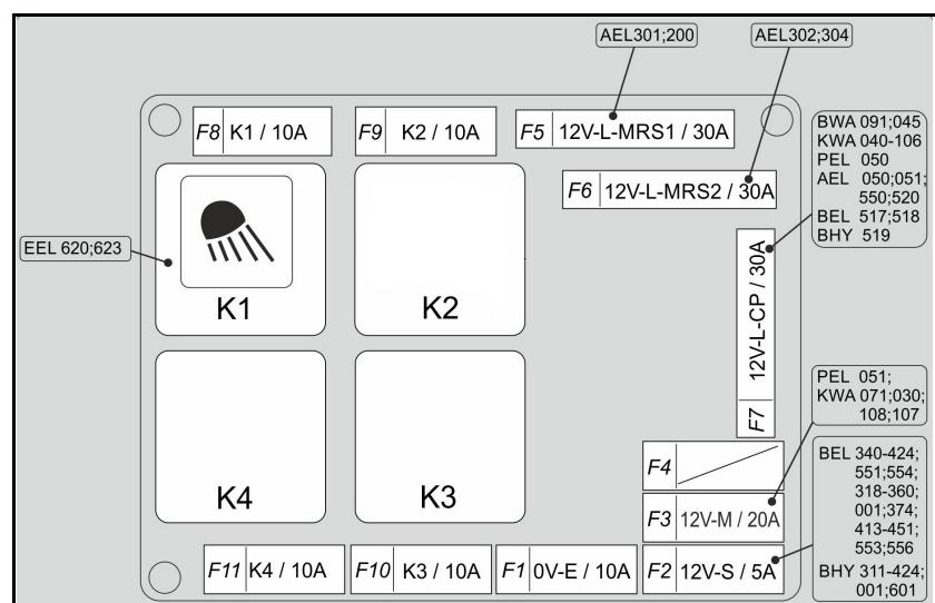
Предохранители на панели управления
