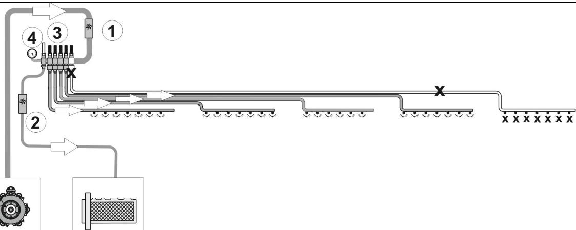
Распределительные трубопроводы с клапанами секций и системой принудительной циркуляции DUS
