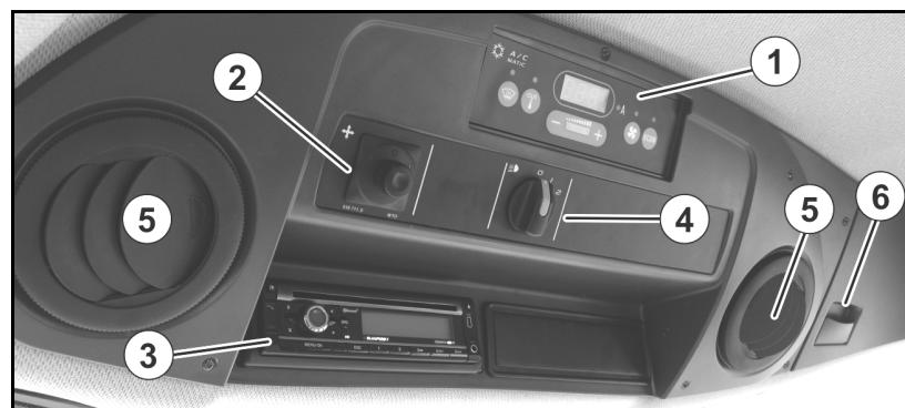
На потолке располагаются переключатели для вентилятора, системы обогрева, кондиционера, системы освещения и регулирования зеркал, а также для радио.
