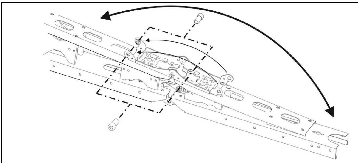
2 винта фиксируют сложенный и разложенный наружный элемент в соответствующих конечных положениях.
