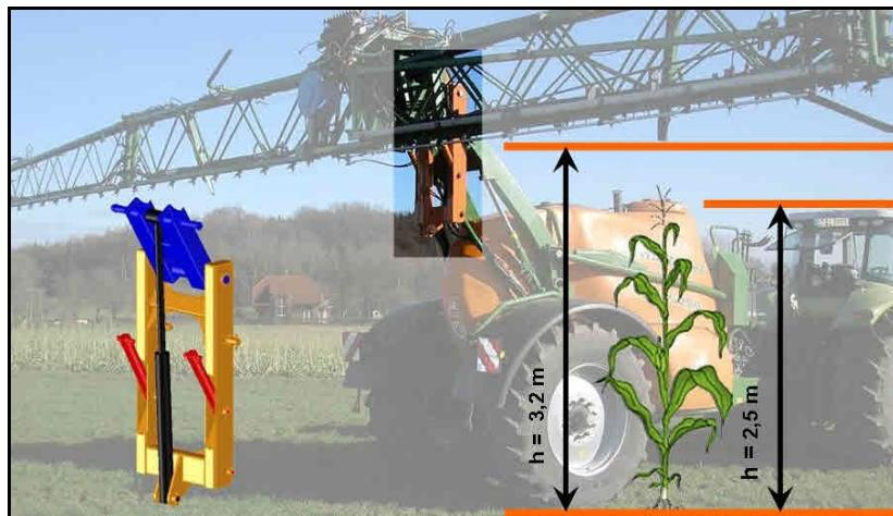
Модуль подъема поднимается и опускается при помощи терминала управления.
