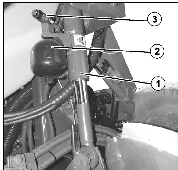
Перед погрузкой опустите машину посредством гидропневматической подвески.
