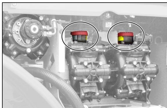
1. Проверьте, виден ли уровень масла на метке при неработающем и находящемся в горизонтальном положении насосе.
