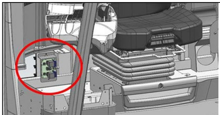
**Предохранители в кабине сзади справа**
