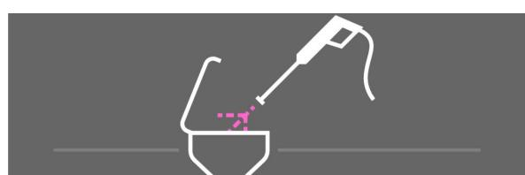
10. Для постановки на зимнее хранение внешней очистки: промойте распыливающий наконечник через бак-смеситель.
