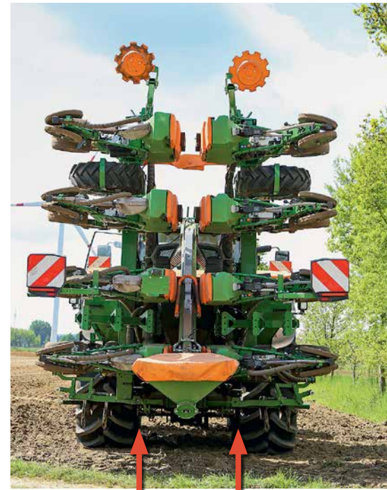
Недалеко от загрузочного шнека распознаются сегменты рамы с различной длиной
