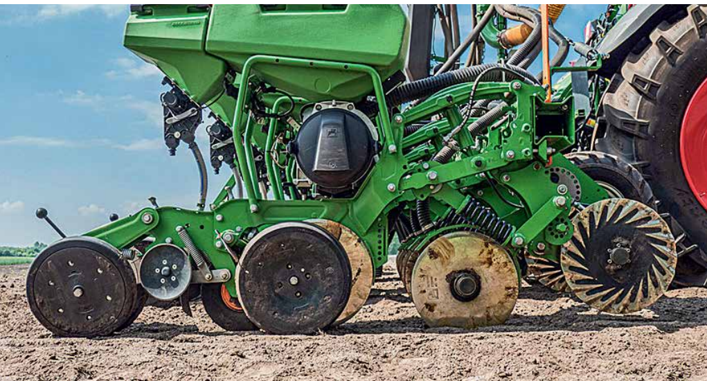
По желанию клиента производитель может предложить устройство относительной регулировки сошника для внесения удобрений в зависимости от глубины заделки семян
