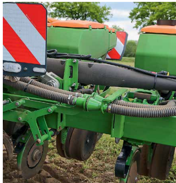
Внешние шланги подачи удобрений в процессе складывания и раскладывания разъединяются/стыкуются автоматически
