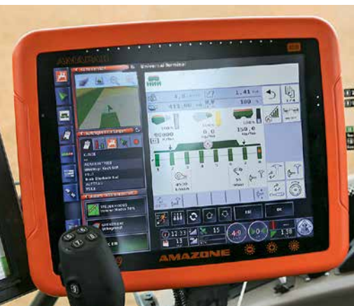
Сеялка совместима с протоколом ISOBus, а управление машиной может осуществляться посредством самых разных терминалов
