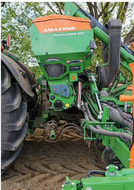
Этот бункер для удобрений вмещает 1250 л. Устройство для выставления нормы высева имеет удобный доступ
