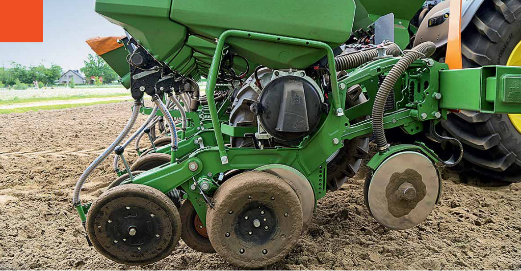
Семенные бункеры вмещают теперь целых 70 л. На фото – высевашающий аппарат с фиксированной настройкой сошника для внесения удобрений
