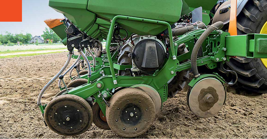
Семенные бункеры вмещают теперь целых 70 л. На фото – высевательный аппарат с фиксированной настройкой сошника для внесения удобрений
