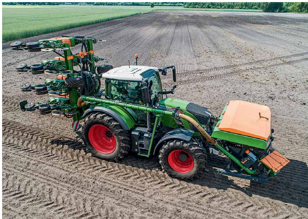
Шестиметровую раму можно использовать и без компонентов для внесения удобрений или с фронтальным бункером для удобрений
