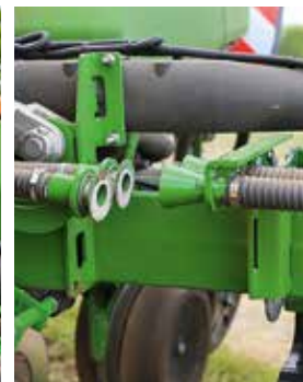
Zewnętrzne węże nawozowe podczas składania są automatycznie łączone lub rozłączane.
