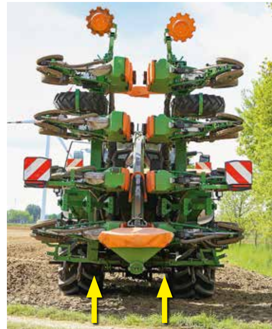
Oprócz ślimaka napętniającego widać segmenty ramy o różnych długościach.
