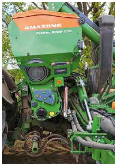
Ten zbiornik na nawóz ma pojemność 1250 l. Dostęp do wykonania próby kręconej jest dobry.
