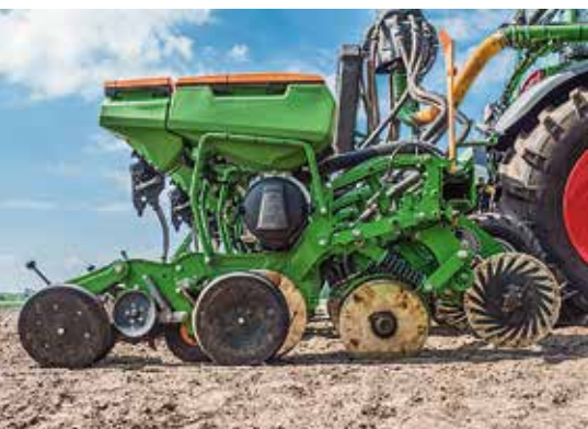
W opcji są redlice nawozowe, które utrzymują głębokość dozowania stosownie do głębokości siewu.
