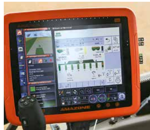
Maszyna jest kompatybilna z ISOBUS i może być obsługiwana przez różne terminale.
