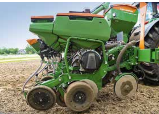
Zbiorniki na nasiona mają teraz pojemność 70 litrów. Agregat z regulacją głębokości redlic nawozowych.
