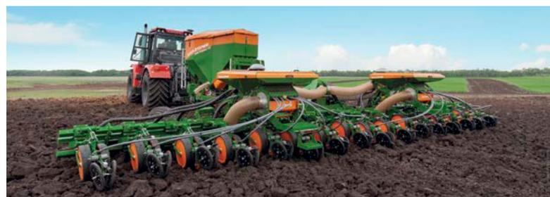
keit auf unebenen Feldern. Darüber hinaus besitzt sie einen zentralen Behälter für den Dünger und zwei zentrale Behälter für das Saatgut. Dadurch ist nicht nur die Befüllung sehr einfach, sondern auch ein Wechsel des Saatgutes ist schnell ohne großen Reinigungsaufwand möglich.
