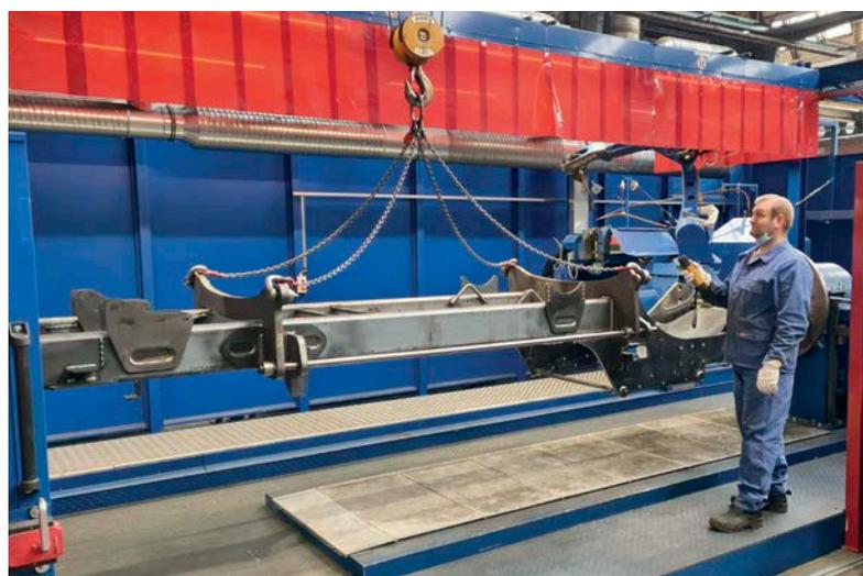
16 m lange Roboterschweißanlage im Zweigwerk Hude
