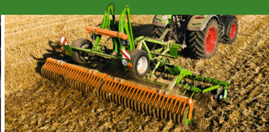
Catros-2TS und Catros + -2TS mit Schwenkfahrwerk Arbeitsbreite: 4 m, 5 m und 6 m
