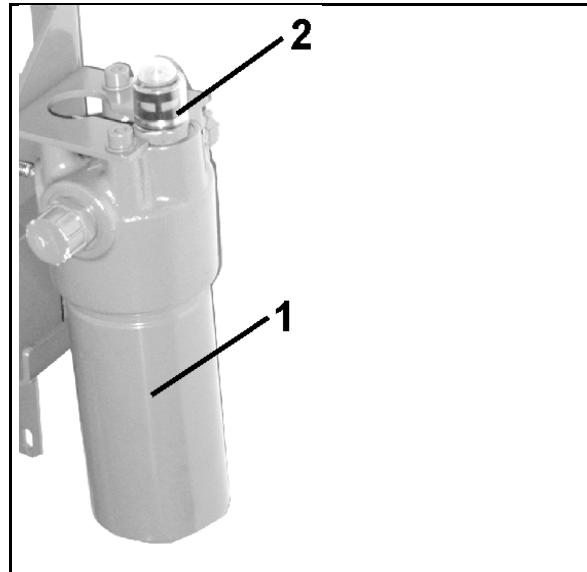
更换油过滤器后，将污染指示器按回原位。
