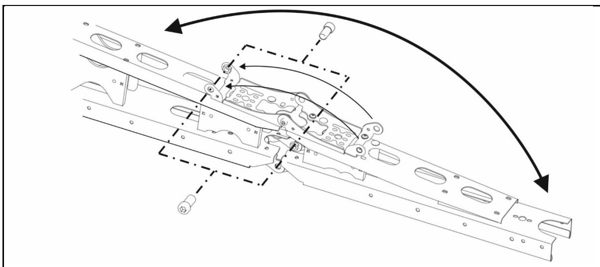
2 个螺栓将折叠和展开的外部元件固定到各自的终端位置。
