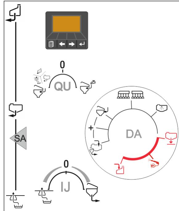
**将防冻剂泵入到喷雾剂罐中：**
