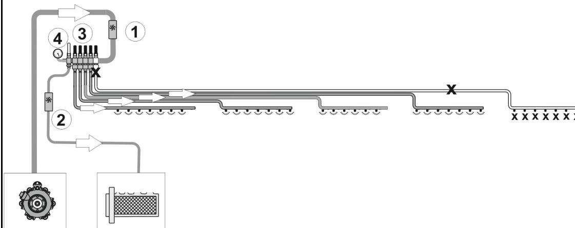
带喷杆组阀门和压力循环系统 DUS 的喷雾管路
