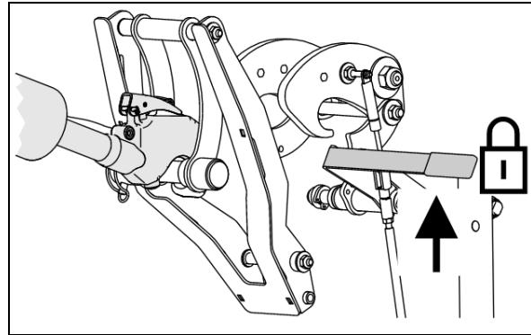
8. 将拖拉机朝机器方向移动，直到连接系统通过棘爪锁定上连杆。
