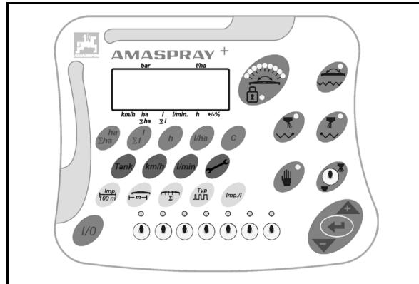
系统在不断地测算当前的喷洒量、速度、已喷洒的面积、总面积、已喷洒量、总量、工作时间、已行走路程。
