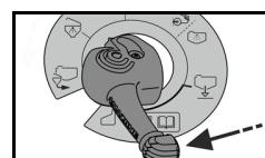
4. Odvodněte tlakový filtr přes uzavírací kohout DE.
