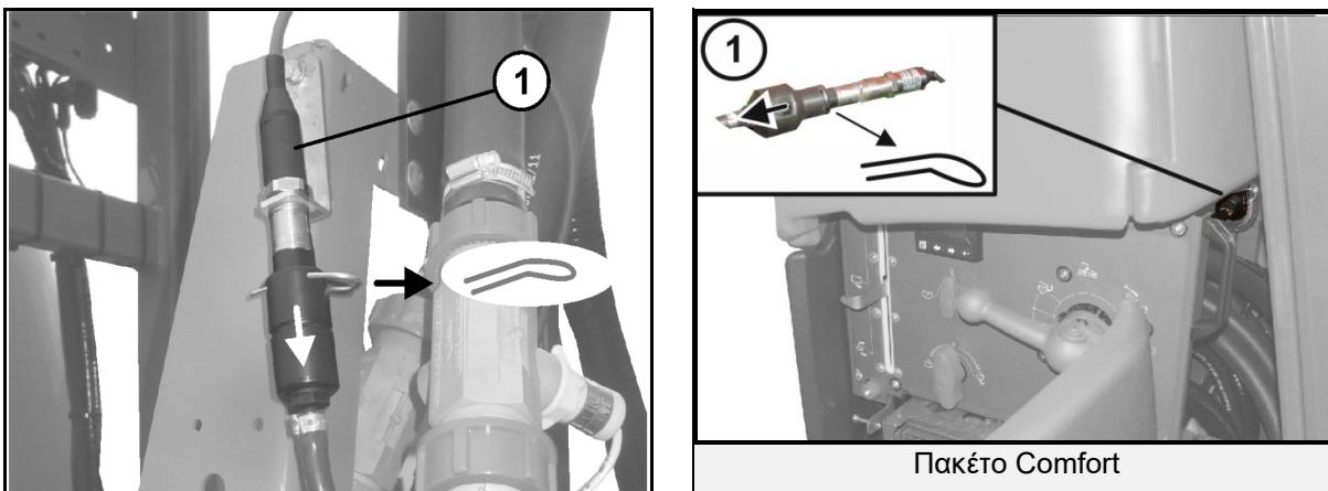
24. Αποστραγγίστε τη χειροκίνητη διάταξη πλύσης και αφήστε ανοιχτή τη βάνα.
