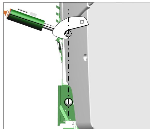
1. Ρυθμίστε τους κάτω βραχίονες τρακτέρ στο ίδιο ύψος.
