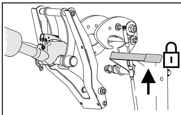
8. Najízdějte traktorem ke stroji, dokud spojovací systém nezajistí horní táhlo západkou.
