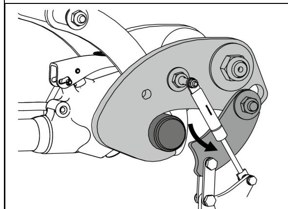
4. Pokud spojovací systém horní táhlo automaticky neuvolní, traktorem trochu couvněte.
