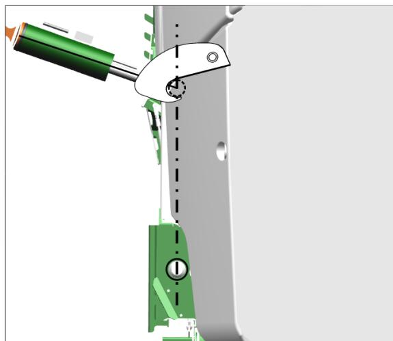
1. Nastavte dolní ramena traktoru na stejnou výšku.
