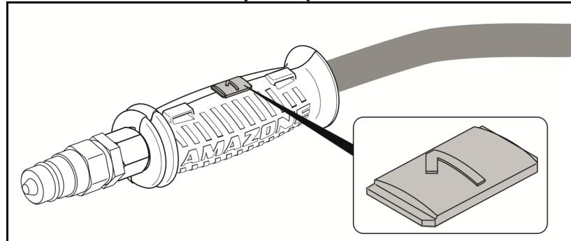
K označením jsou na stroji umístěny nálepky, které objasňují příslušné funkce hydrauliky.
