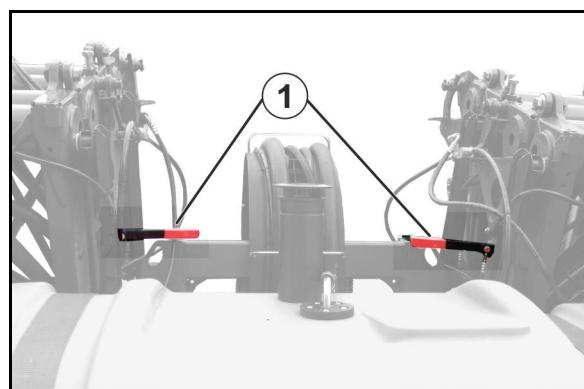
(1) Přepravní zajištění na ramenech Q Plus proti nechtěnému rozložení
