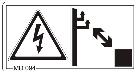
**Jmenovité napětí****Bezpečná vzdálenost k nadzemním vedením**
