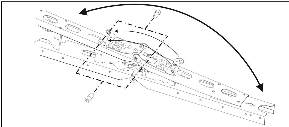
2 šrouby zajišťují složený a rozložený vnější prvek v příslušných koncových polohách.
