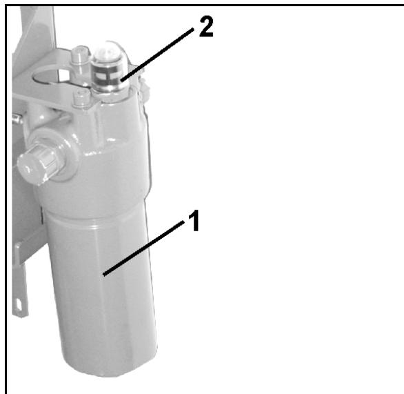
Po výměně olejového filtru znovu zatlačte ukazatel znečištění.
