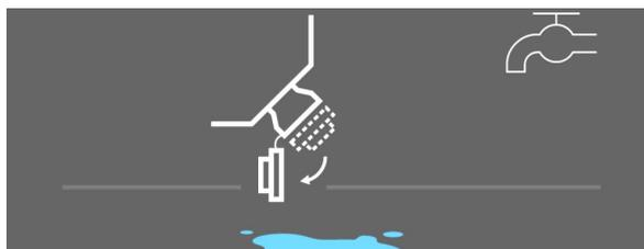
17. Снимите всасывающий шланг или заглушку с всасывающего патрубка.
