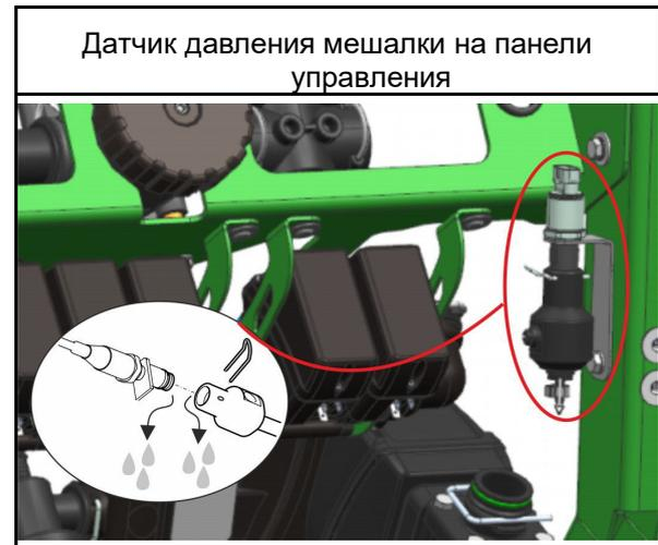
22. Слейте остатки воды из слива линейных фильтров при помощи сливного крана.
