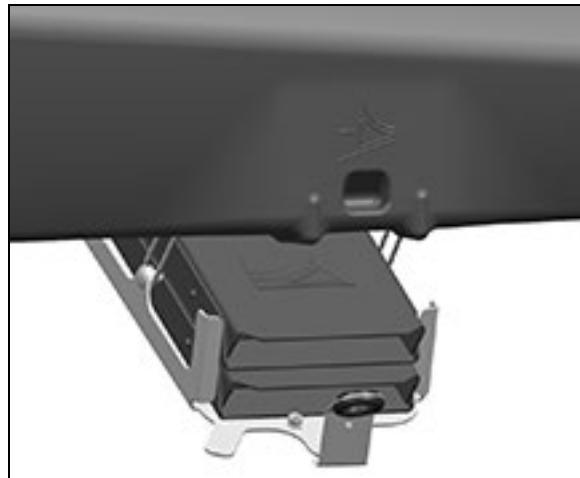
Calele rabatabile de blocare a roților se aduc în poziție de utilizare prin apăsarea butonului și se plasează înainte de decuplare direct la roți.
