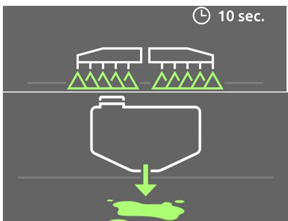
19. H Mašīna ar HighFlow: atūdeņojiet HighFlow: papildu maišanas mehānismu atkal iestatiet iepriekšējā pozīcijā.
