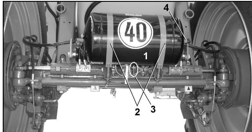
1. Turiet kondensāta noliešanas vārsta gredzenu pavilktu sānis tik ilgi, līdz kondensāts no pneimatiskās sistēmas balona vairs neizplūst.
