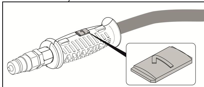
Par markējumiem pie mašīnas ir uzlīmes, kas paskaidro attiecīgās hidrauliskās funkcijas.
