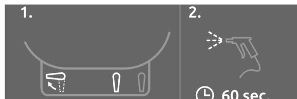
12. Miglošanas pistoles pie ieskalošanas tvertnes ieziemošanai: miglošanas pistoli skalojiet virs ieskalošanas tvertnes 60 sekundes.
