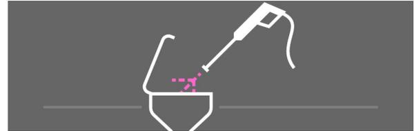
11. Colocar las llaves de conmutación en el depósito de inyección en la posición indicada.
