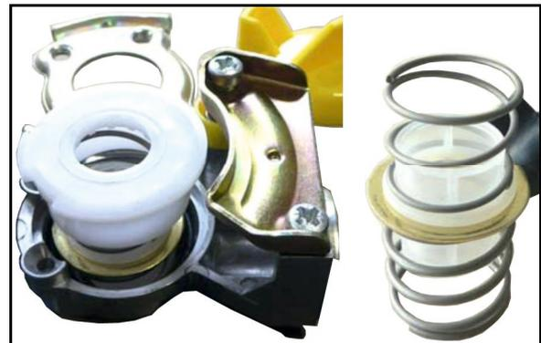
**!** Colocar la junta tórica correctamente en el anillo de plástico.
