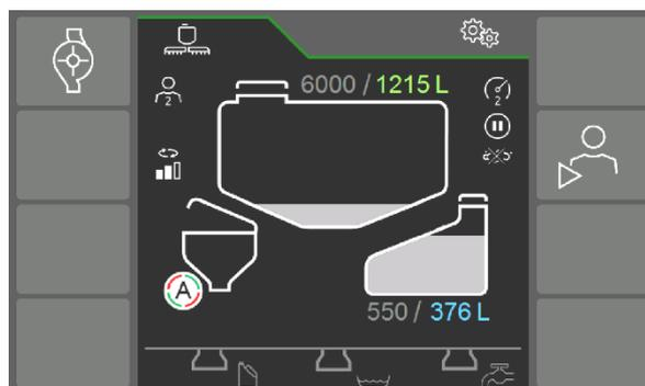
Al seleccionar un tanque se abrirá el submenú con las funciones para el tanque correspondiente.
