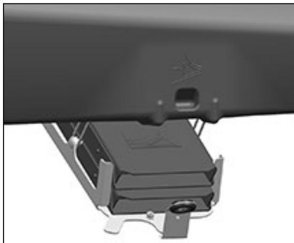
Poner los calces abatibles presionando el pulsador en posición de operación y colocar directamente en las ruedas antes de desacoplar.
