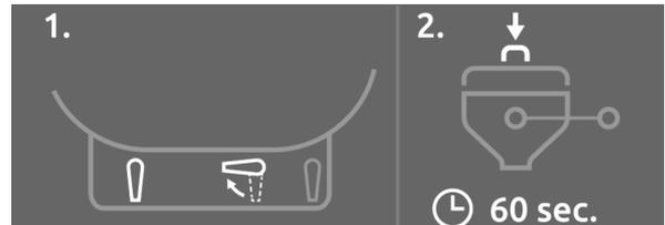
14. Efectuar una limpieza interior del depósito de inyección durante 60 segundos.
