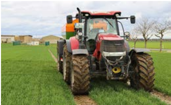
In Kitzen liegt die Spur der Fahrgassen bei 2,25 m. Die gezo-gene Pflanzenschutz-technik gab dieses Maß vor.
