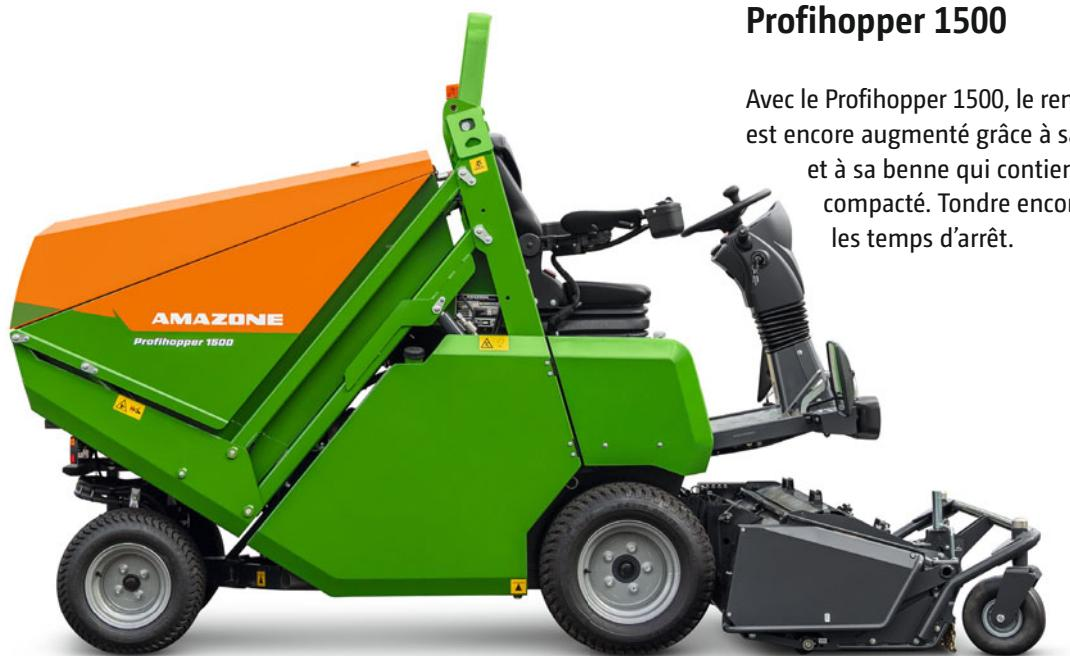
Avec le Profihopper 1500, le rendement élevé du Profihopper est encore augmenté grâce à sa largeur de travail de 1,5 m et à sa benne qui contient 1 600 l de produit de tonte compacté. Tondre encore davantage, réduire encore les temps d'arrêt.
