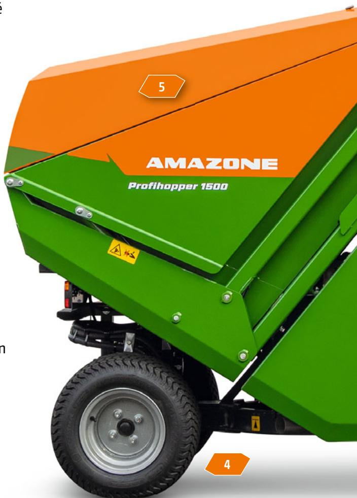
4. Traction intégrale intelligente 4WDi dotée d'une commande individuelle du régime des roues pour permettre un rayon de braquage nul.
