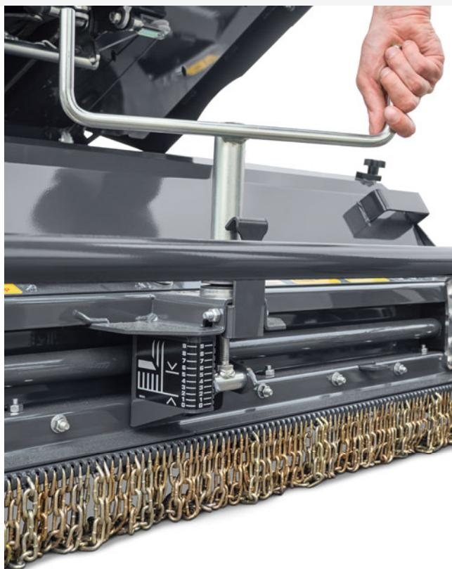
Le réglage simple et précis de la hauteur de coupe garantit un résultat optimal à des hauteurs de coupe entre 0 et 90 mm.
