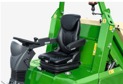
✔ 3 sièges différents offrent la solution adéquate à chaque besoin ! Le NecPlusUltra : Siège "Prestige" Grammer chauffant et avec suspension pneumatique
