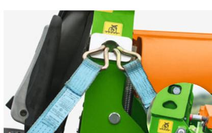
Protection d'arêtes en inox, protège le châssis du frottement des sangles<sup>1+2</sup>
