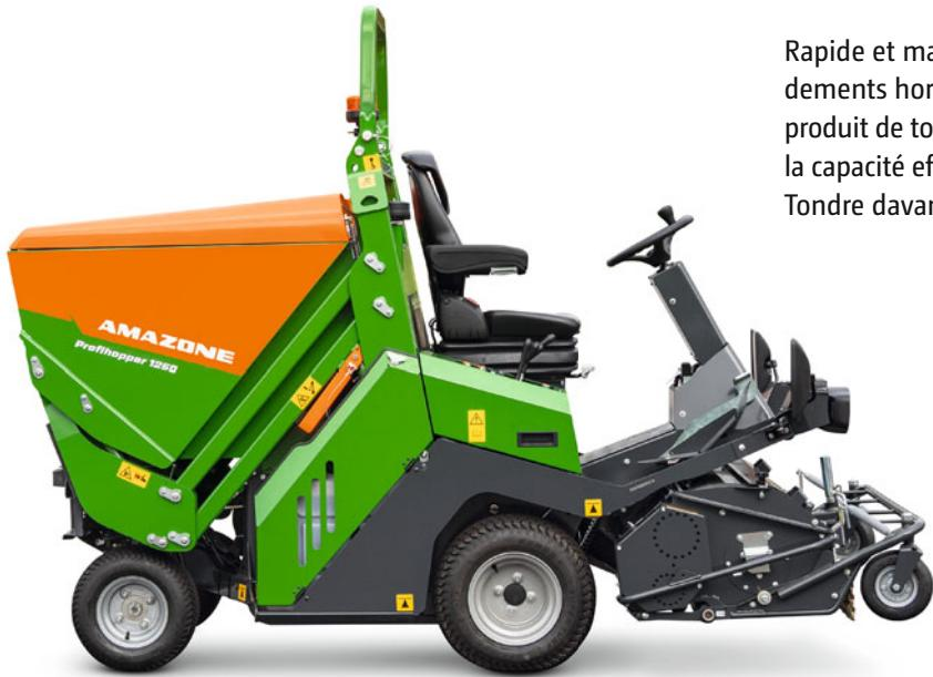
Rapide et maniable – Le Profihopper 1250 permet des rendements horaires élevés avec un compactage extrême du produit de tonte dans la benne, grâce au PowerCompactor – la capacité effective de la benne passe ainsi de 730 l à 1 000 l. Tondre davantage, réduire les temps d'arrêt.
