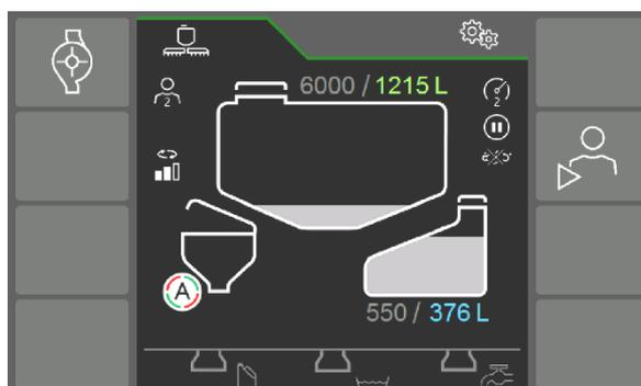
Durch Anwählen eines Tanks wird das Untermenü mit den Funktionen für den jeweiligen Tank geöffnet.
