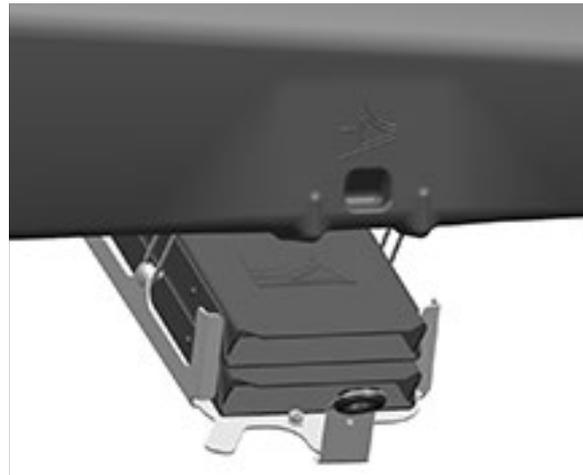
Die klappbaren Unterlegkeile durch Betätigen des Druckknopfes in Einsatzstellung bringen und vor dem Abkuppeln direkt an die Räder anlegen.
