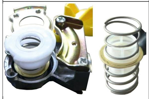
**!** O-Ring korrekt auf dem Kunststoffring positionieren.
