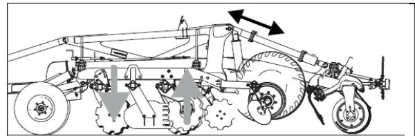
Durch heckseitiges Anheben oder Absenken der Maschine kommt eine der beiden Scheibenreihen weiter in Eingriff und richtet die Maschine hinter dem Traktor aus.
