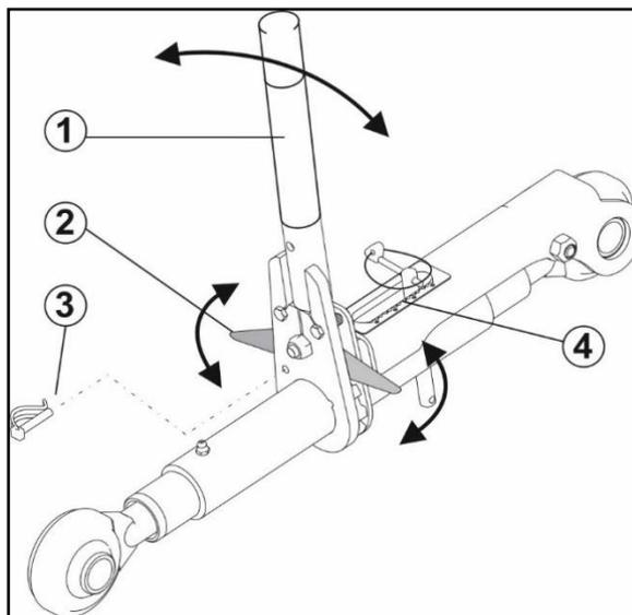
Die Skala (4) dient zur Orientierung bei der Einstellung
