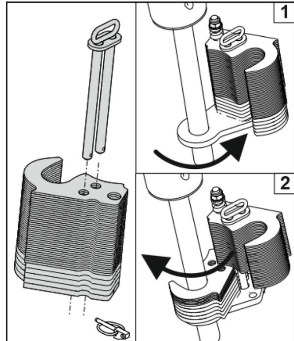
Beide Fahrwerkszylinder gleich einstellen!
