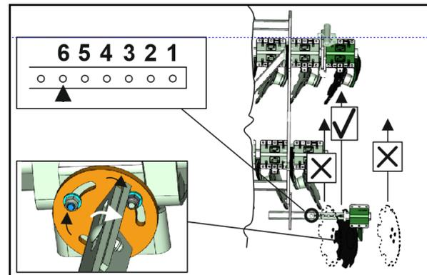
Zur Vermeidung von Schrägzug der Maschine kann die hintere Scheibenreihe hydraulisch oder manuell in der Tiefe angepasst werden.
