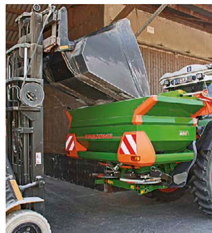
Пълнене с промишлена багерна лопата
