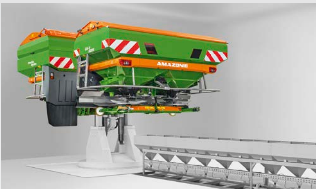
Съвременно тестово хале за тороразпръсквачки
