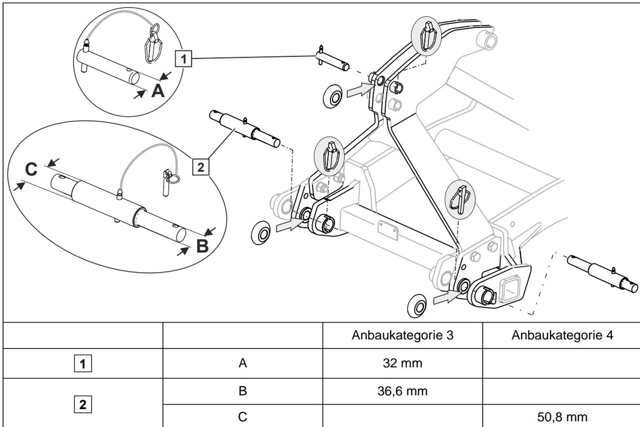
1. Kugelhülse mit Oberlenkerbolzen **1** einbauen.
