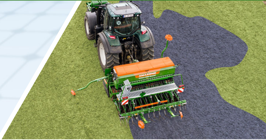
Variable Mengenausbringung für eine teilflächenspezifische Saat
