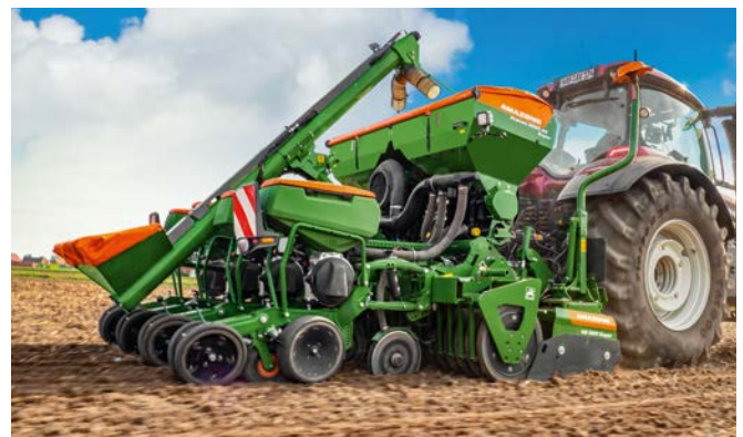
Aufgebaute Einzelkorn-Sämaschine Precea 3000-ACC, 4-reihig
