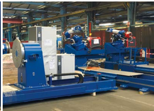
Zwei neue Roboterschweißanlagen – eine noch im Aufbau befindlich
