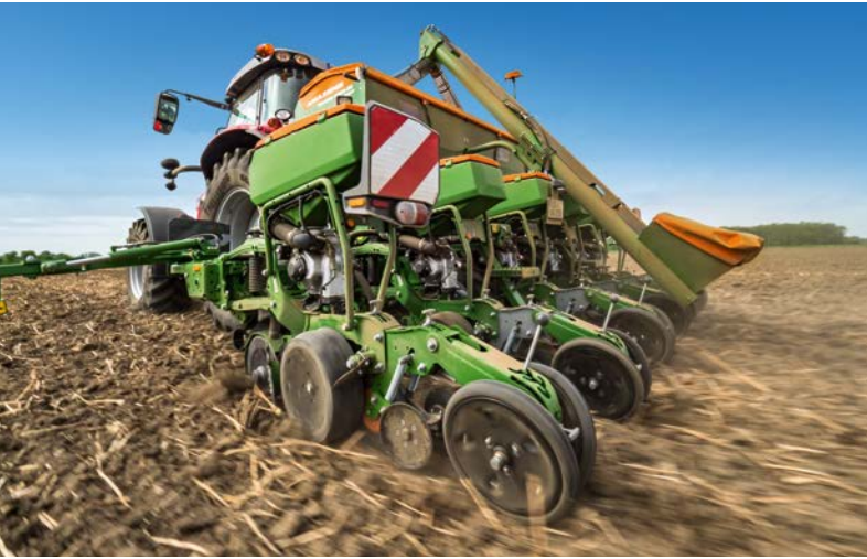
Einzelkorn-Sämaschine Precea 4500-2CC, 6-reihig
