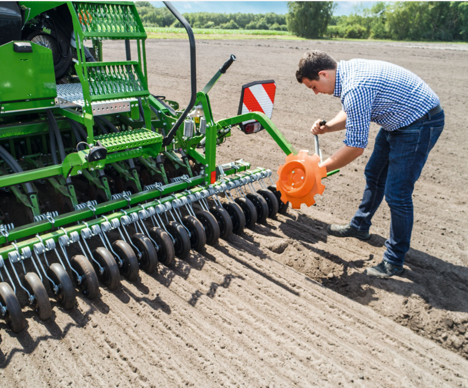
Réglage du marquage de jalonnages avec l'outil universel
