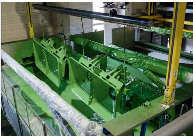
L'apprêt par immersion cathodique de tous les composants permet d'obtenir une protection anticorrosion optimale.
