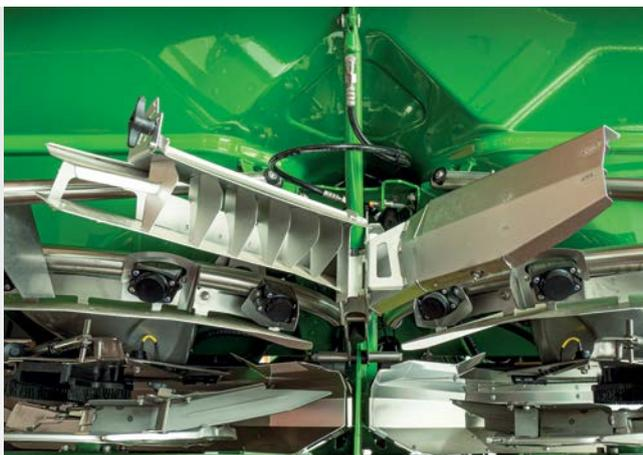
Le déflecteur BorderTS est monté au centre derrière l'épandeur et il est activé hydrauliquement.
