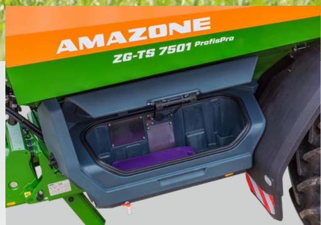
Les boîtes en plastique des deux côtés avec réservoir intégré pour le lavage des mains offrent un espace de rangement suffisant
