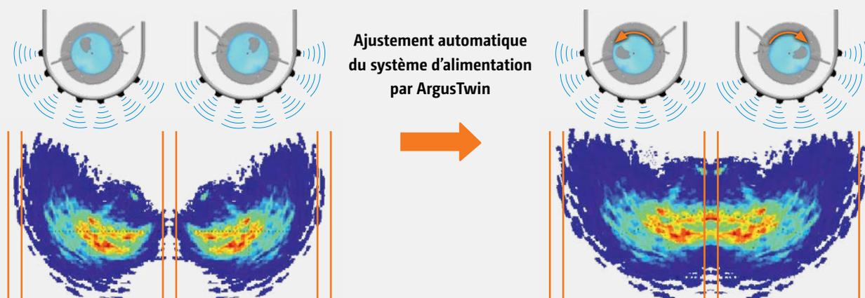
Problème en cours d'épandage – mauvaise répartition transversale, par exemple suite à une modification des caractéristiques de l'engrais
