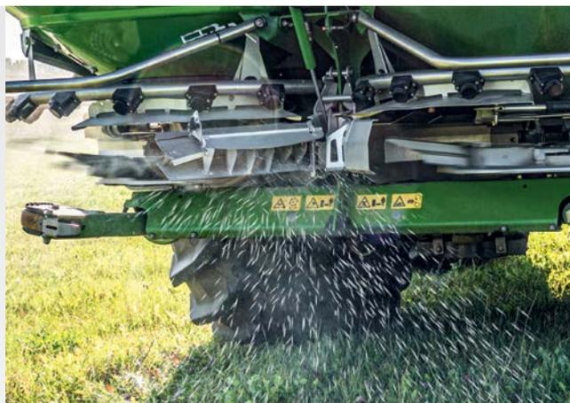
En position active, sur le ZA-TS le déflecteur BorderTS est abaissé pour guider la nappe d'épandage tel que désiré. Grâce à la structure spéciale des lamelles et à la tôle de guidage réglable en continu, les granulés sont dirigés en douceur vers le sol.
