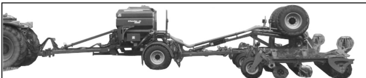
El XTender se acopla al tractor por medio del dispositivo de conexión de la lanza.
