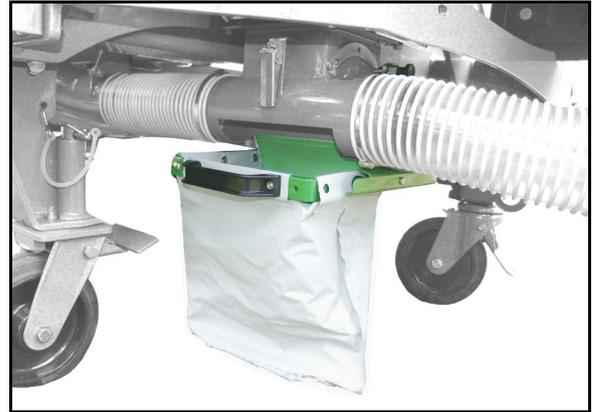
5. Efectuar la calibración siguiendo las instrucciones de servicio del software hasta que la cantidad distribuida sea la deseada.
