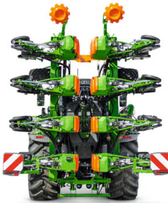
9 soros Precea 6000-2FCC összecsuksukva közúti szállításához
