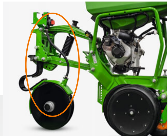
Folyékony műtrágya készlet a FerTeC Twin műtrágyacsoroszlyánál
