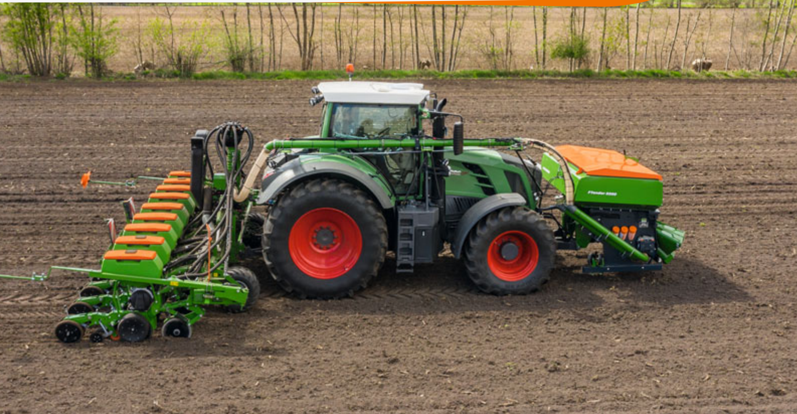
FTender 2200 fronttartály Precea 6000-2FCC szemenkénti vetőgéppel
