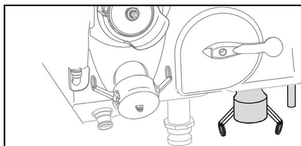
2. Postavite preklapni ventil **SA** u položaj
