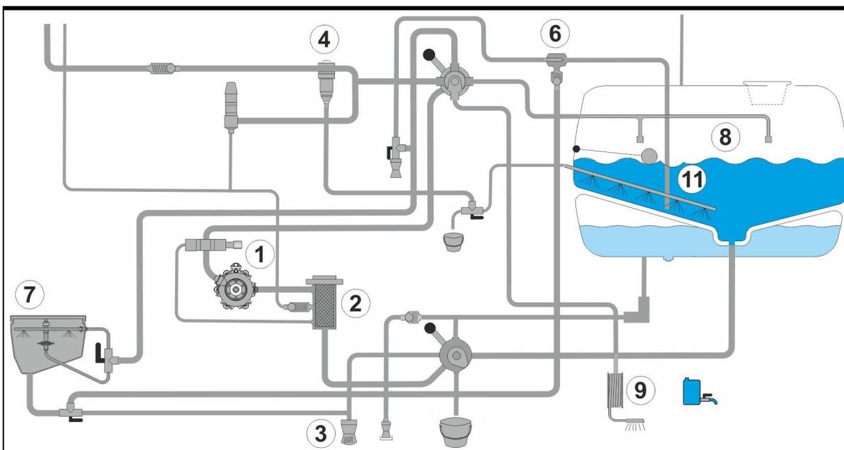
La bomba de pulverización (1) aspira por medio de la grifería de aspiración y el filtro de aspiración (2)
