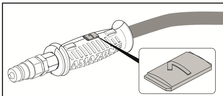
Las marcas llevan láminas pegadas a la máquina para explicar las funciones hidráulicas correspondientes.
