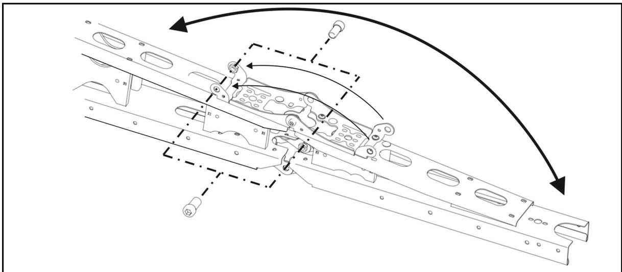
2 Schrauben sichern das eingeklappte und ausgeklappte äußere Element in den jeweiligen Endstellungen.
