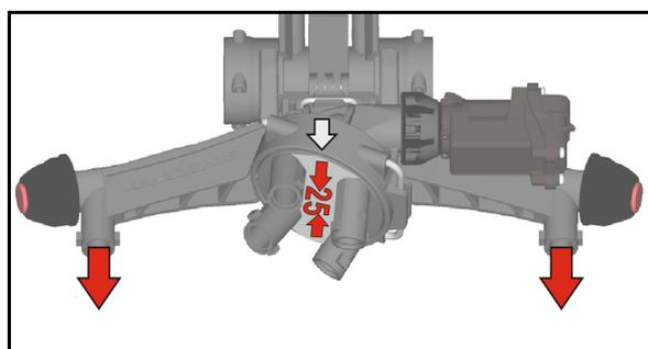
25 cm Düsenaufnahme montieren.
