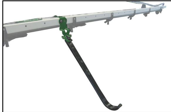
Bei Verwendung einiger Düsen liegen die Abstandshalter im Spritzkegel.
