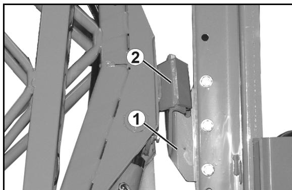
Kontrollieren Sie die Verriegelung des Super-S-Gestänges mit Hilfe der Sichtprüfung.
