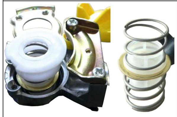
**!** O-Ring korrekt auf dem Kunststoffring positionieren.
