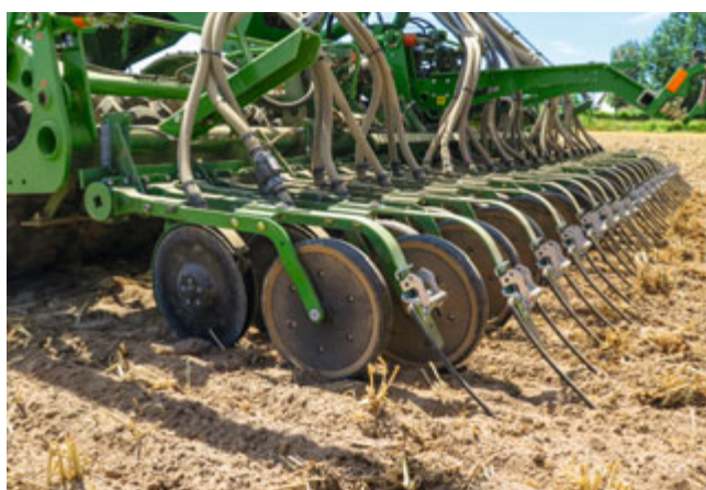
Сошник TwinTeC plus с гидравлической регулировкой давления на сошник
