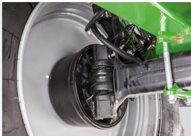
Bremskraftregelung durch elektronisches Bremssystem (EBS)
