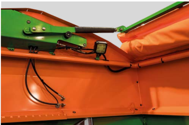
Arbeitsbeleuchtung im Behälterinnenraum
