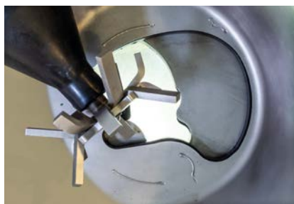
Stufe 2: Trichteröffnung halb geöffnet
