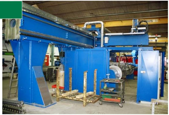
Portalroboter zum Schweißen von Sämaschinen-Rahmen
