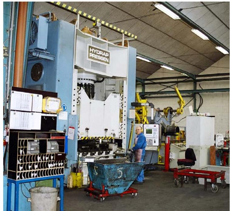
400 t Hydraulikpresse mit automatischer Zuführung vom Coil
