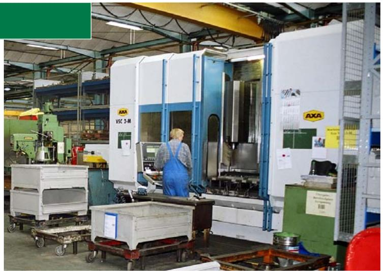
Bearbeitungszentrum spanabhebende Fertigung
