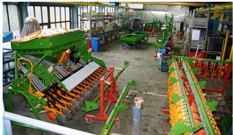
Endmontage der Pneumatik-Drillmaschinen
