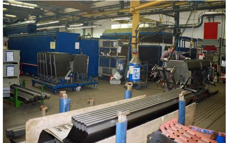
Heften und Schweißen mit Roboter von konventionellen Sämaschinen
