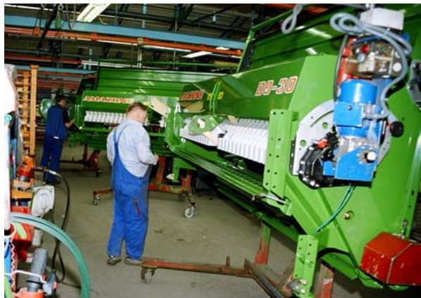
Probelauf der D9-Sämaschinen
