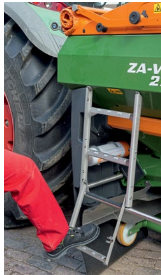
Die Plane hat uns sehr gut gefallen, vor allem auch die Position zum Waschen und Trocknen. Eine Tankbeleuchtung fehlt leider. Der auf beiden Seiten angebrachte klappbare Aufstieg hat stabile und sichere Tritte.
