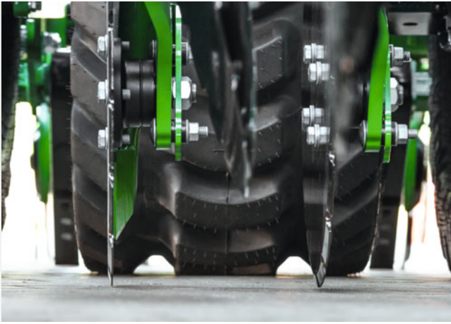
Die FerTeC-Schare sind zwischen den Reihen der Säschar positioniert.
