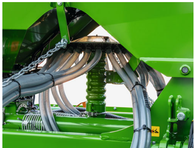
Der Verteilerkopf für die Förderstrecke zu den FerTeC-Scharen befindet sich gut zugänglich und platzsparend unter dem Behälter.
