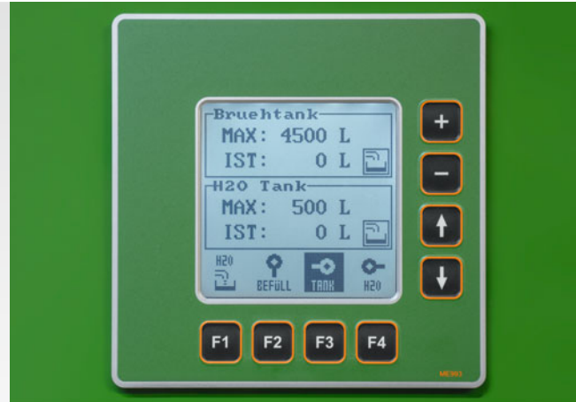
Eingabe des Sollfüllstands für den Spritzflüssigkeits- und Spülwassertank über das TwinTerminal beim Comfort-Paket 2
