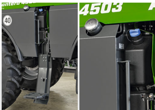
Tanktreppe zum gut zugänglichen Diesel- und DEF-Tank
