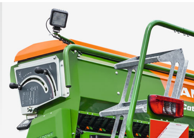
Arbeitsbeleuchtung über AmaDrill 2 schaltbar
