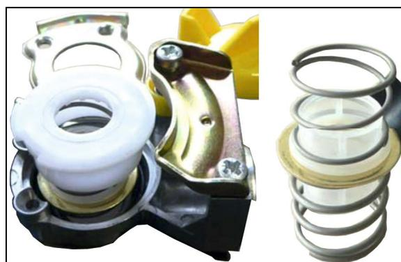
**!** O-Ring korrekt auf dem Kunststoffring positionieren.
