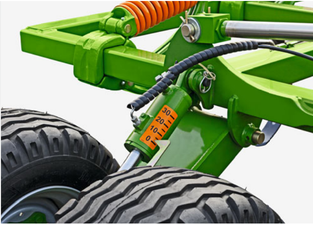
Skala der vollhydraulischen Arbeitstiefenverstellung des Zinkenfeldes
