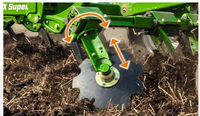
Das Randelement – separat in Höhe und Neigung einstellbar
