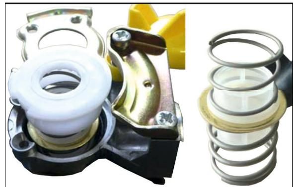
**!** O-Ring korrekt auf dem Kunststoffring positionieren.
