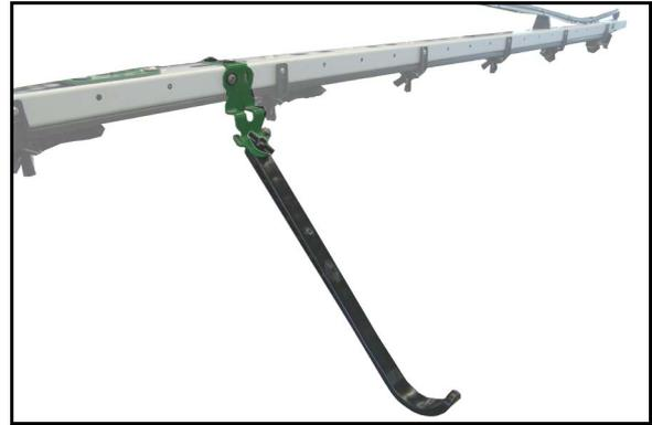
Bei Verwendung einiger Düsen liegen die Abstandshalter im Spritzkegel.
