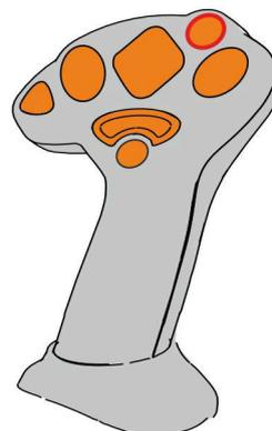
Eine Folie mit der Standardbelegung kann in die Kabine geklebt werden. Für eine frei wählbare Tastenbelegung kann die Standardbelegung überklebt werden.
