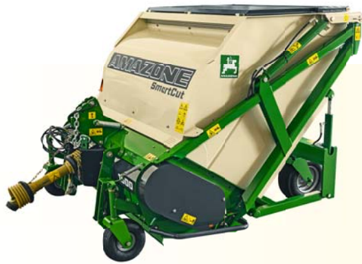
Tosaerba SmartCut GHL-T 1500 con attacco a tre punti
