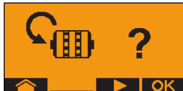
7. **OK** Επιβεβαιώστε ότι είναι ανοιχτό το κλαπέτο κάτω από τον δοσιμετρικό τροφοδότη και ότι έχει τοποθετηθεί από κάτω ένα δοχείο συλλογής.
