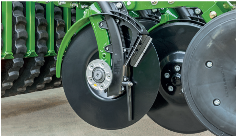
Bild 2: TwinTeC-Doppelscheibenschar mit Hartmetallinnenabstreifer und Tiefenführungsrolle
