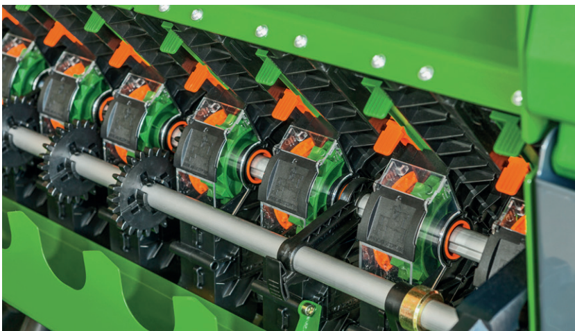
Bild 3: Precis-Dosiersystem mit Feinsärad (orange) und Normalsärad (grün) und zugehörigen Schließschiebern
